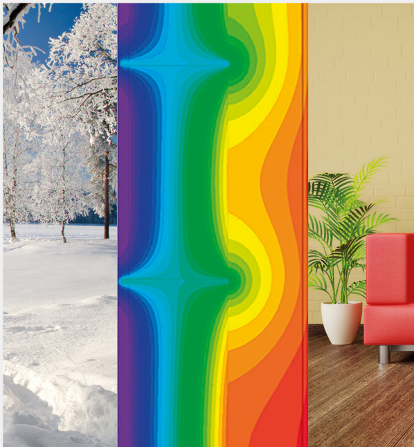
Ausgeprägte Wärmebrücke bei Aluminiumkonsolen
