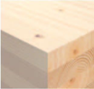
Brettschichtholz/Balkenschichtholz aus Fichte, Tanne, Kiefer
