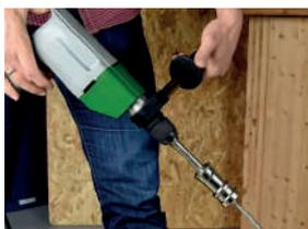
Für schwer zugängliche Stellen und bei einem hohen Durchsatz an Schrauben ist das SPAX Einschraubwerkzeug die perfekte Hilfe. Es sorgt für eine zuverlässige Fixierung der SPAX Schraube und verhindert ein Abrutschen oder Herunterfallen. So können Sie sicherer und schneller arbeiten und schonen Werkzeug und Bit.
