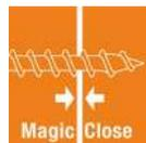
Patentiertes Vollgewinde zieht Holzbauteile ohne Vorspannen spaltfrei zusammen.
