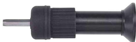
Besonders leicht verarbeiten Sie diese Schrauben mit unseren **Einschraubhilfen TK8 und TK8-L**. Damit erreichen Sie den korrekten Anpressdruck der Dichtscheibe und somit eine perfekte Abdichtung am Einschraubloch. Weitere Informationen hierzu erhalten Sie auf der **Seite 137**.
