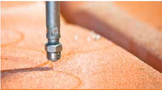
Konturgenaues Schneiden mittels Wasserstrahl
