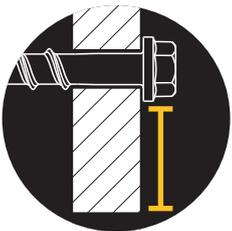
Durch **spreizdruckfreie Verankerung** ist die Montage bei geringen Rand- und Achsabständen möglich
