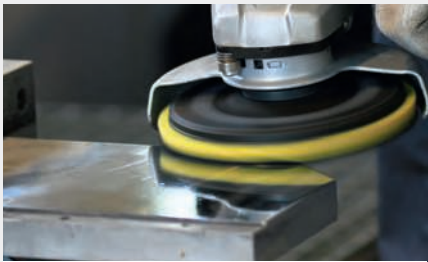
Anschließende Spiegelglanz-Politur mit BRIGHTEX® Poliersystem (Berry + Sun).
