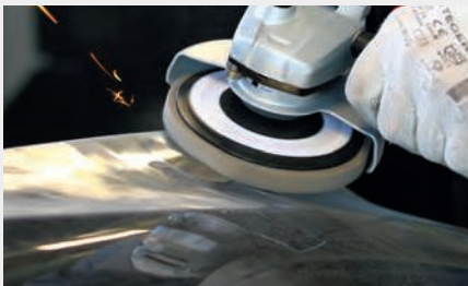
Entfernt gleichzeitig Kratzer, kleine Schweißpunkte und -nähte.
