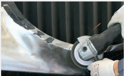
Entlackung mit gleichzeitigem Oberflächen-Finis .
