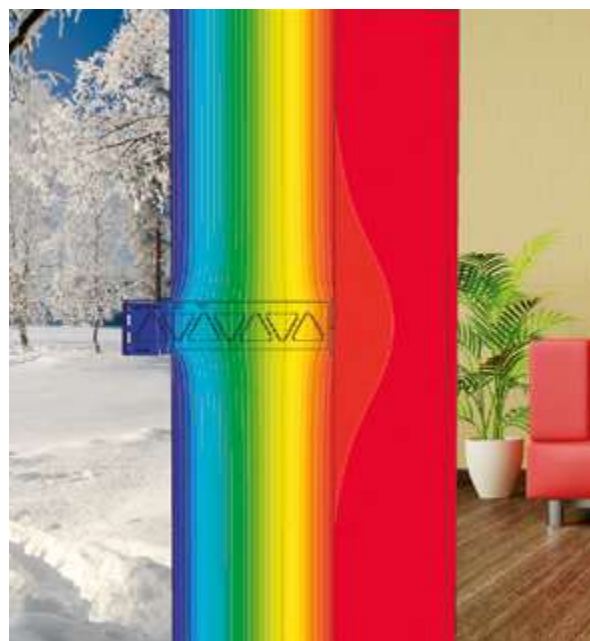
Abbildung 2 Minimale Wärmebrücke bei CROSSFIX®
