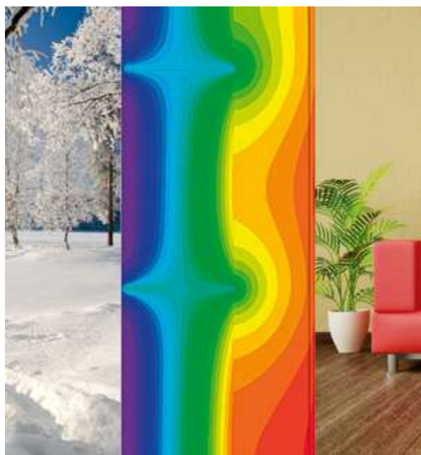
Abbildung 1 Ausgeprägte Wärmebrücke bei Aluminiumkonsolen
