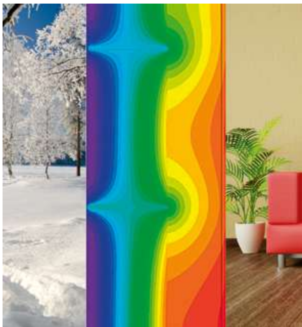
Abbildung 1 Ausgeprägte Wärmebrücke bei Aluminiumkonsolen
