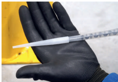
3.) Mischerreduzierspitze auf Statikmischerdüse stecken. Falls erforderlich, kann Klebeband verwendet werden.
