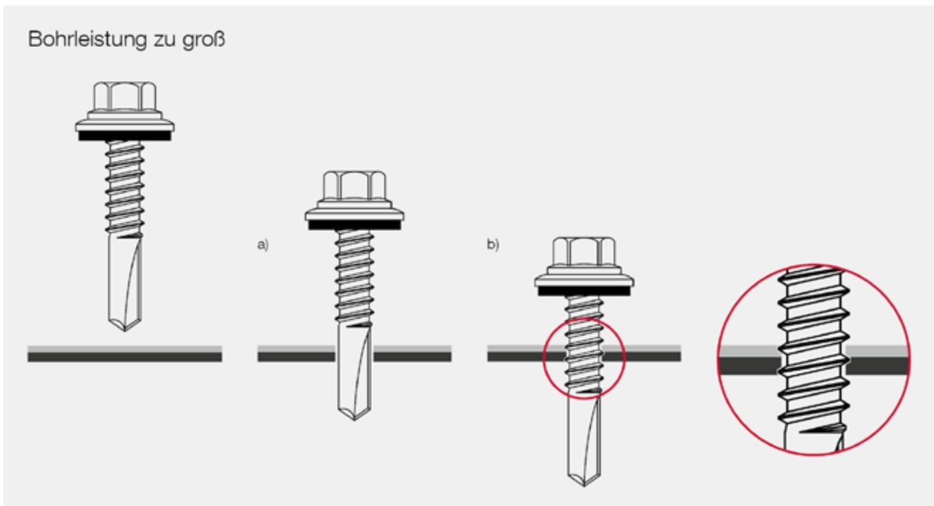
Ist die Bohrleistung (alternativ auch Bohrkapazität genannt) zu gering (a), kommt es während des Bohrvorgangs zu einem Zwangsvorschub der Schraube. Der Zwangsvorschub entsteht, wenn der Bohrvorgang noch nicht abgeschlossen ist, das Gewinde der Schraube aber schon in den Eingriff kommt (b). In diesem Moment ist der Vorschub, der durch die Gewindesteigung erzeugt wird
