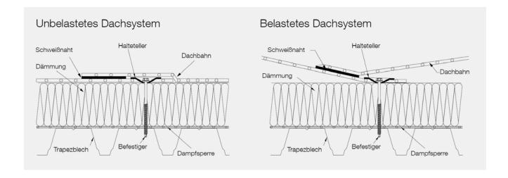
Am Beispiel einer Saumbefestigung werden ein unbelastetes und ein belastetes System gezeigt. Beim belasteten Dachsystem ist zu erkennen, wie sich die Dachbahn aufgrund der Windsogbelastung nach oben wölbt. Dies führt zu einer Belastung im Saumbereich. Die Windsogkräfte werden gleichmäßig zu 50 Prozent vom Saumbereich aufgenommen und über den Befestiger in die Tragkonstruktion abgeleitet.
