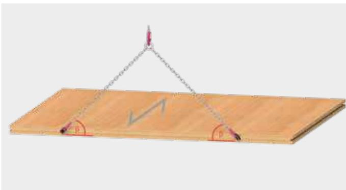
BSH-Wand oder-Träger liegend, Faserverlauf: vertikal
