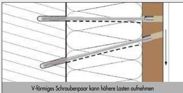
Um dem System EiSYS-Holz eine höhere Steifigkeit zu geben, werden die Verstellerschrauben paarweise und V-förmig angebracht.
