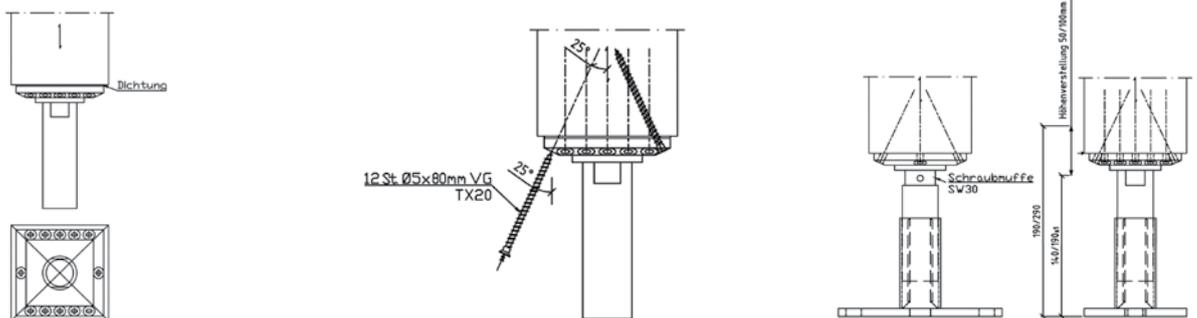
Der Stützenfuß Pedix kann einfach am Hirnholzschnitt angebracht werden: Die Dichtung auf den Stützenfuß legen und beide Teile zentrisch auf der Hirnholzfläche platzieren. Hinweis: Zur leichteren Montage können Fußplatte und Abdeckhülse abgeschraubt werden.
