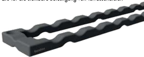
Die Dista-Leiste 2.0 wird mit Terrasotec-Schrauben Ø4 mm in den dafür vorgesehenen Bohrungen befestigt und fixiert (für eine Dista-Leiste 2.0 werden 5 Terrasotec-Schrauben benötigt).
