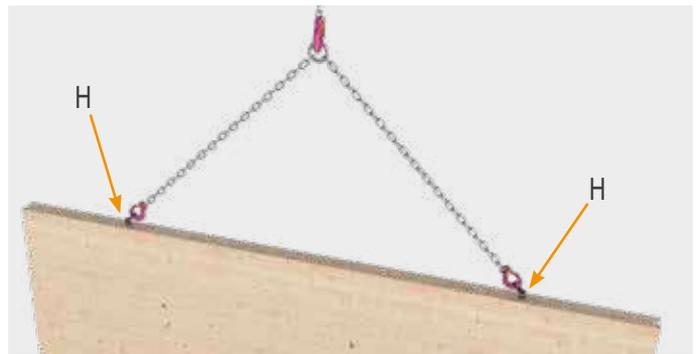
Anheben einer stehenden Wand mittels zwei montierter Hebeanker HebeFix Mini und Kugeltragbolzen (H) an der Schmalseite.
