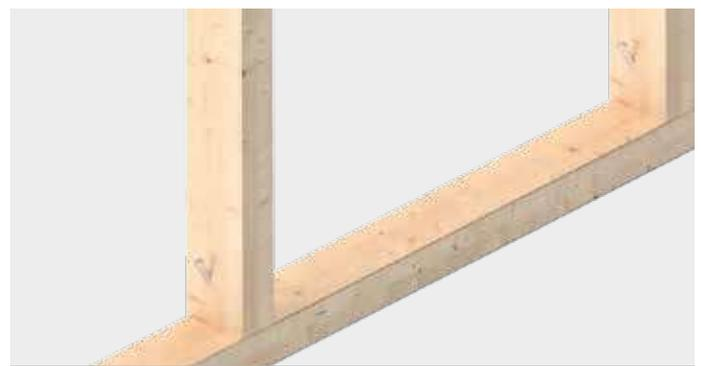
Befestigung von Stützen bei Holz-Rahmenkonstruktionen im Fußschwellerbereich
