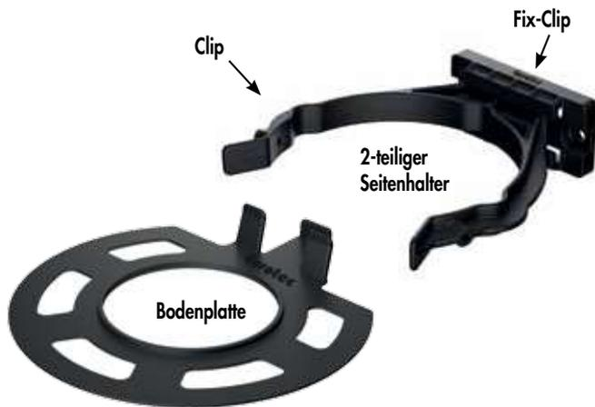
Der Eurotec Blendhalter Terrasse ist mit den Verstellfüßen PRO M und L verwendbar. Er wurde entwickelt um den Anwendern einen optisch ansprechenden Abschluss von Terrassen zu ermöglichen. Der Blendhalter Terrasse setzt sich zusammen aus einer Bodenplatte und einem Seitenhalter. Für Montagezwecke ist der Seitenhalter in zwei Einzelteile, dem Clip und dem Fix-Clip, zerlegbar.
