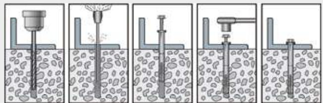
**Unser Tipp:** Bei Loch- und Hohlblocksteinen im Drehgang bohren. Ohne Schlagfunktion! Entfernen Sie das Bohrmehl aus dem Bohrloch!
