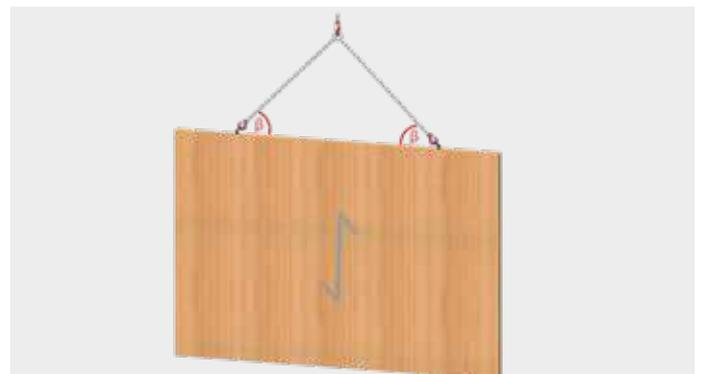
BSH-Wand oder-Träger stehend, Faserverlauf: vertikal
