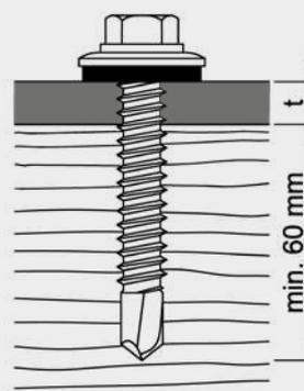
Stahl an Holz/Holz an Holz für BiGHTY Bi-Metall 6,5 x L, Bohrleistung 5 mm
