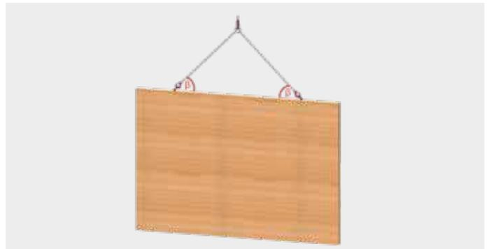
BSH-Wand oder-Träger stehend, Faserverlauf: vertikal
