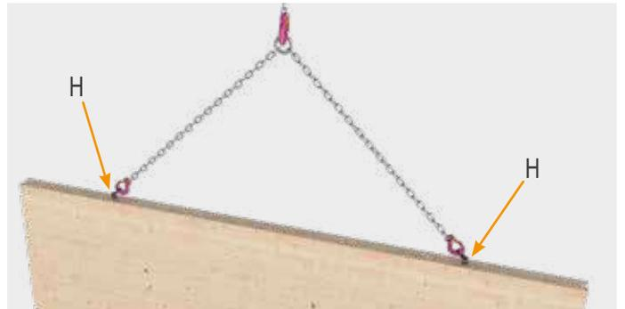
Anheben einer stehenden Wand mittels zwei montierter Hebeanker HebeFix und Kugeltragbolzen (H) an der Schmalseite.
