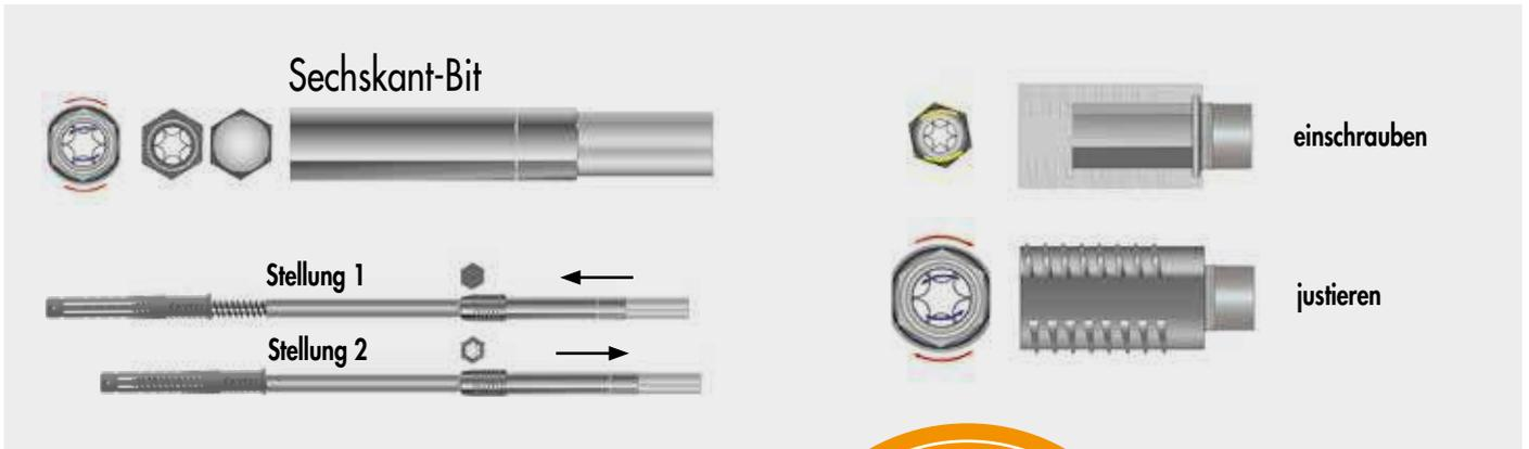
Die EiSYS-Holz Schraube ist mit einer freidrehenden Justierhülse/Verstellkopf ausgestattet, die eine Distanzregulierung zwischen Mauerwerk und Unterkonstruktion ermöglicht. Als Zubehör wird ein Sechskant-Bit mitgeliefert. Dieses wird sowohl zum Einschrauben der Schraube in den Untergrund, als auch zum Justieren der Unterkonstruktion durch den Verstellkopf genutzt.
