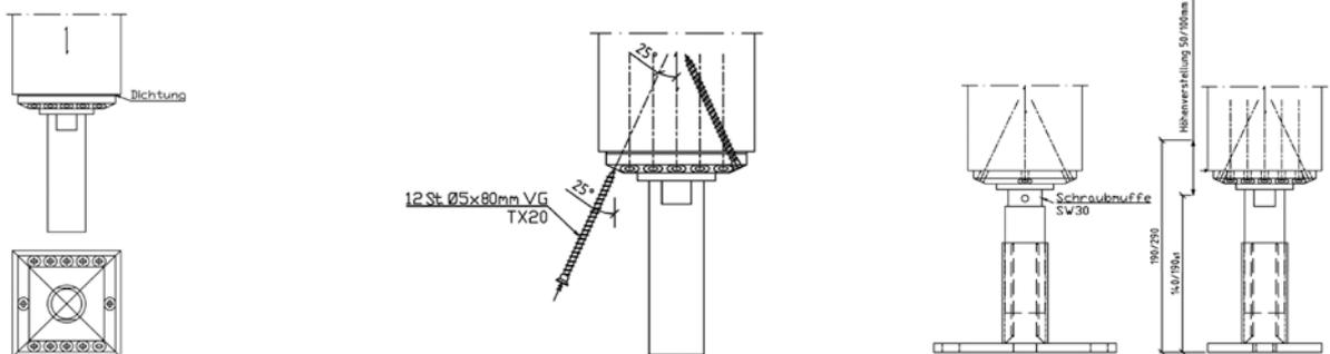
Der Stützenfuß Pedix kann einfach am Hirnholzschnitt angebracht werden: Die Dichtung auf den Stützenfuß legen und beide Teile zentrisch auf der Hirnholzfläche platzieren. Hinweis: Zur leichteren Montage können Fußplatte und Abdeckhülse abgeschraubt werden.
