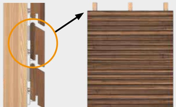
Für Bereiche in denen sich Fenster, Türen, Dielenstöße oder das Ende der Fassade befinden, können Dank der Lochung der Fassadenclip-Rhombus, Fixpunkte ausgebildet werden. Hierzu wird der Clip zuerst auf der Rückseite des Profils verschraubt. Anschließend kann der Clip mit der Unterkonstruktion verschraubt werden.
