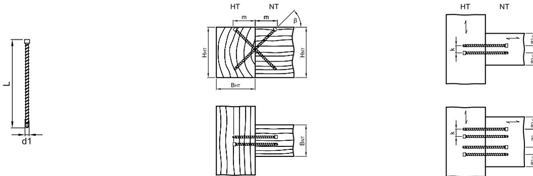
$a_1 = \text{min. } 50 \text{ mm}, a_2 = \text{min. } 30 \text{ mm}, k = \text{min. } 15 \text{ mm}$
