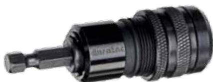
Der Screw Stop ist die ideale Lösung, um Schrauben gleichmäßig tief ins Holz zu versenken. Ihre Terrasse erhält somit ein ansprechendes, gleichmäßiges Oberflächenbild. Mit dem stufenlos verstellbaren Tiefenanschlag stellen Sie einfach die gewünschte Senktiefe ein. Wenn diese beim Einschrauben erreicht ist, kuppelt sich der Antrieb aus und die Schraube stoppt. Sie brauchen nicht noch einmal ansetzen, um den Sitz des Schraubenkopfes zu korrigieren.
