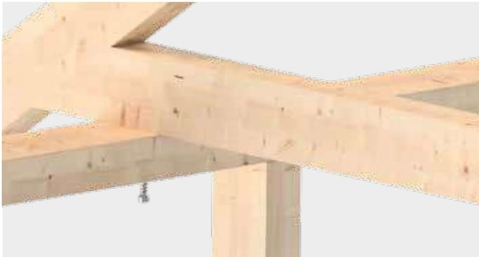
Befestigung von Querträgern bei leichten Holz-Rahmenkonstruktionen
