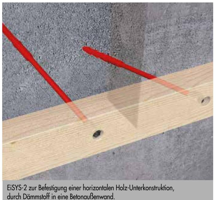
EiSYS-2 zur Befestigung einer horizontalen Holz-Unterkonstruktion, durch Dämmstoff in eine Betonaußenwand.
