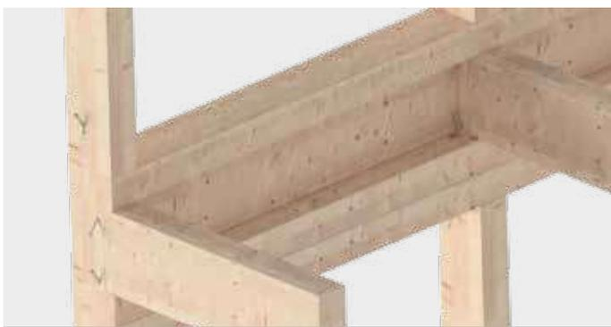
Befestigung von Stützen bei Holz-Rahmenkonstruktionen sowie Haupt-/Nebenträger-Anschlüssen
