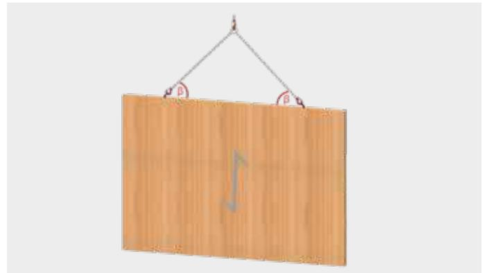
BSH-Wand oder-Träger stehend, Faserverlauf: vertikal
