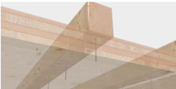
KonstruX DUO zur Befestigung eines Überzugs
