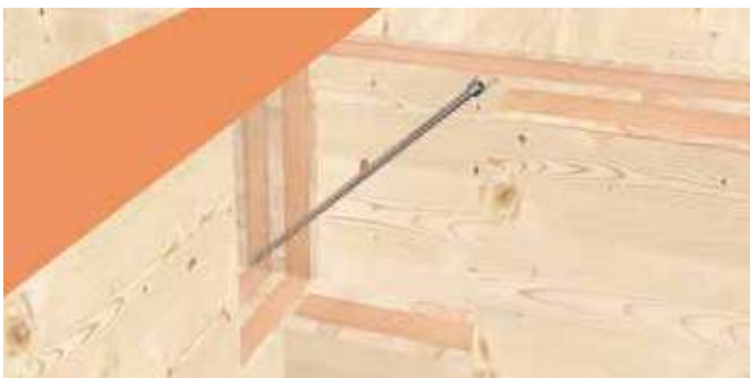
Verbindung von Wand und Balken für den Deckenunterzug.
