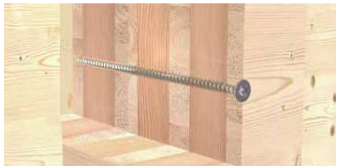
Verbindung von Wand und Stütze für den Deckenunterzug.
