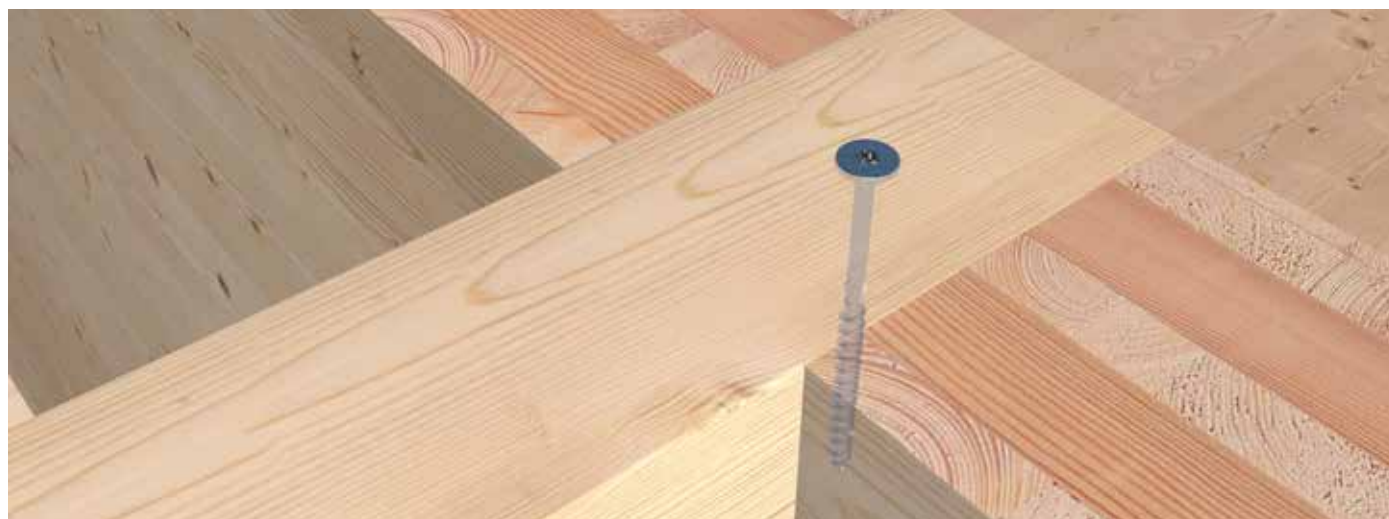
Mittels der SawTec Teilgewindeschraube wird ein Unterzug an der ausgeklinkten CLT-Wand befestigt.
