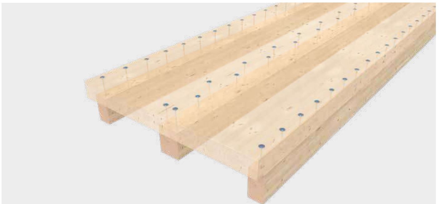
Pressdruckverteilung bei der Schraubenpressklebung von Holzrippenelementen
