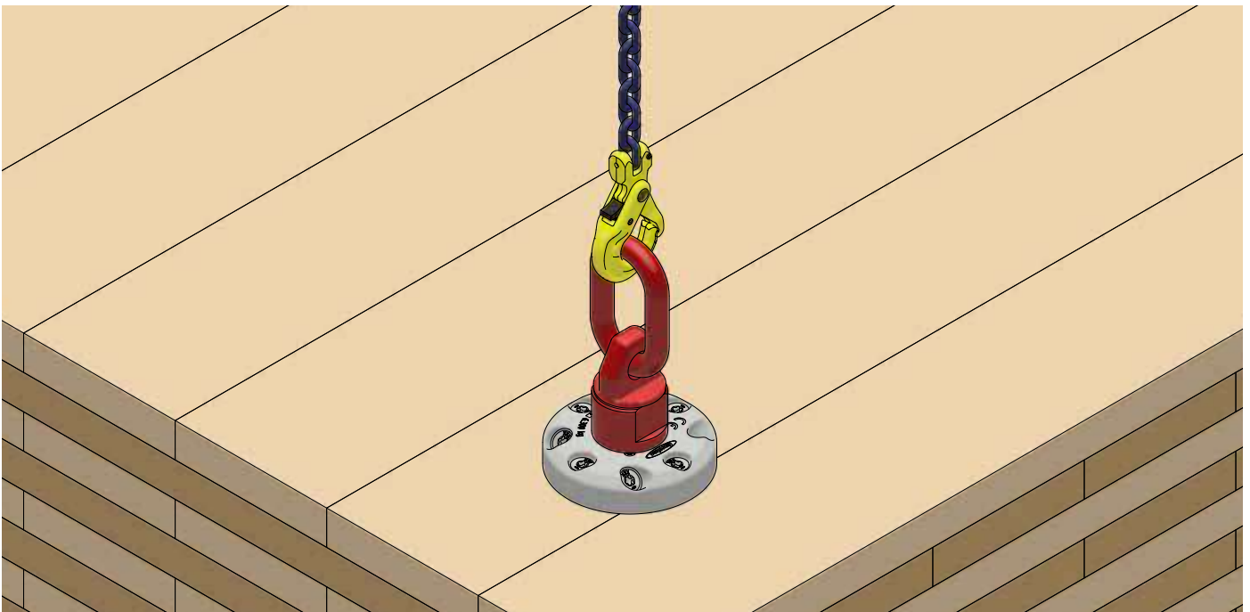
Schritt 4: Powerring im vorher bestimmtem Winkel (siehe technische Daten) einhaken und heben.
