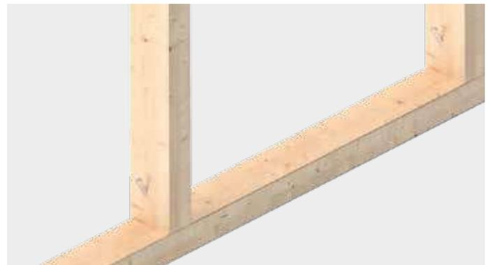
Befestigung von Stützen bei Holzrahmenkonstruktionen im Fußschwellenbereich
