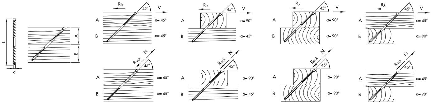
Charakteristischer Wert der Tragfähigkeit der Verbindung  $R_{ox,k}$  bzw.  $R_k$  nach ETA-11/0024
