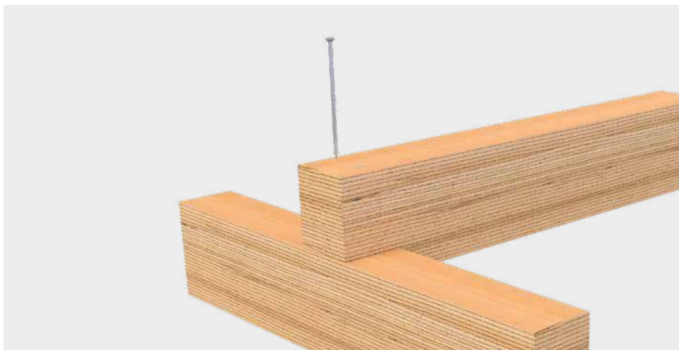
Die LBS Konstruktionsschraube in Buchenfunierschichtholz
