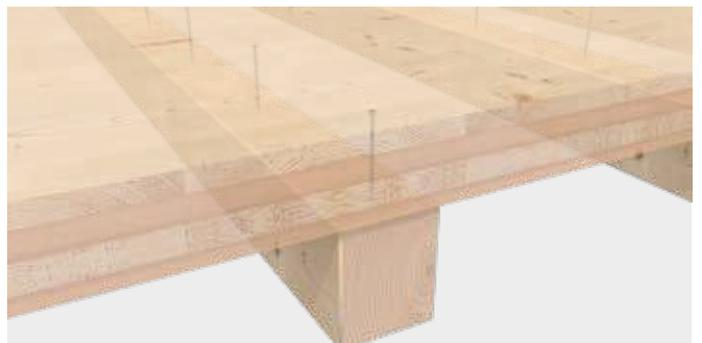
KonstruX DUO zur Befestigung eines Unterzugs
