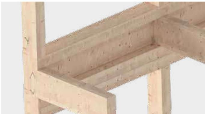
Befestigung von Stützen bei Holzrahmenkonstruktionen sowie Haupt-/Nebenträger-Anschlüssen
