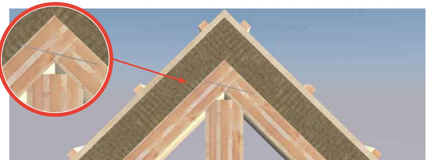
*Dachplatten auf Stoß – Schrägverschraubung*
