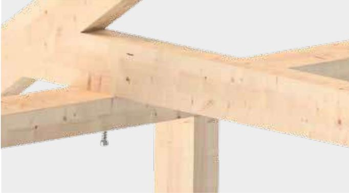
Befestigung von Querträgern bei leichten Holzrahmenkonstruktionen
