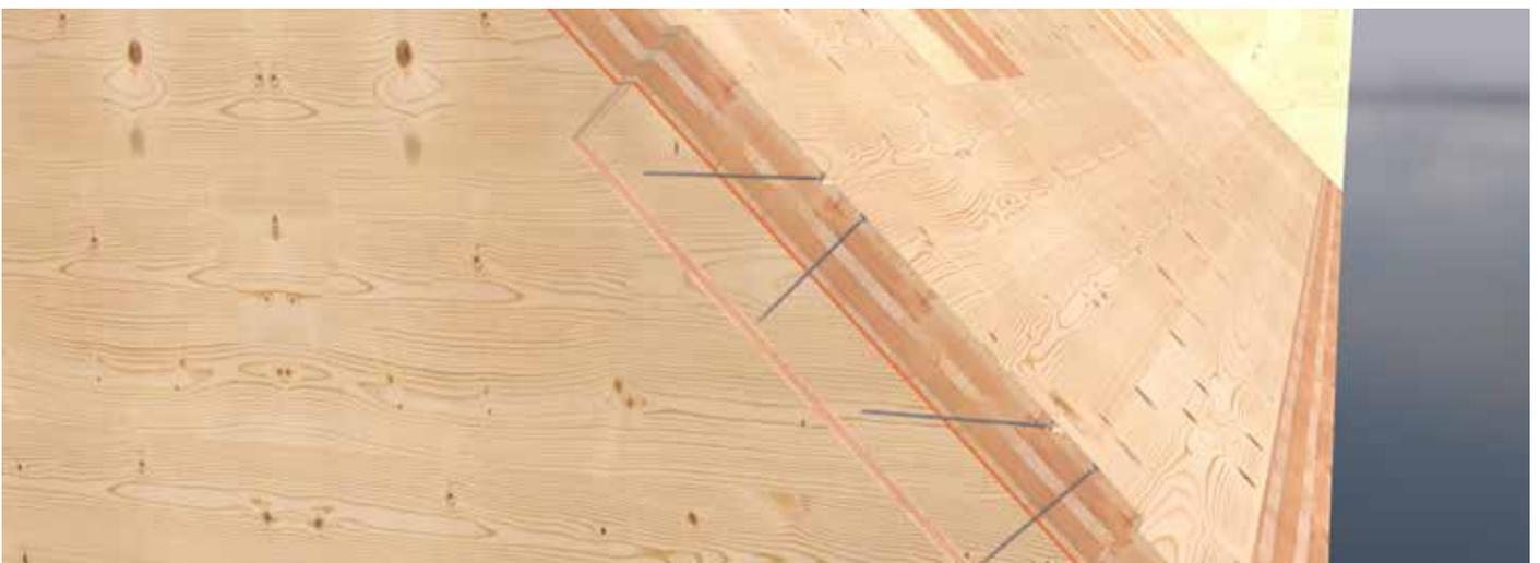
Verbindung von Dach- und Wandelement
