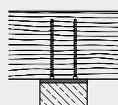
Querzugverstärkung an Ausklinkung
