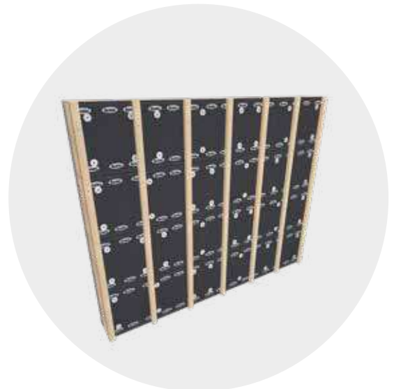
Aufbau einer Unterkonstruktion
