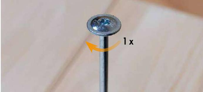
Wir empfehlen, die Eurotec Holzbauschrauben in einem **ununterbrochenen Einschraubvorgang** zu installieren. Unterbrechen und Wiederaufnehmen der Installation erhöht oft die Schwierigkeit und kann auch **Schäden des Schraubenkörpers** durch die Heiß-Kalt-Übergangszone verursachen.
