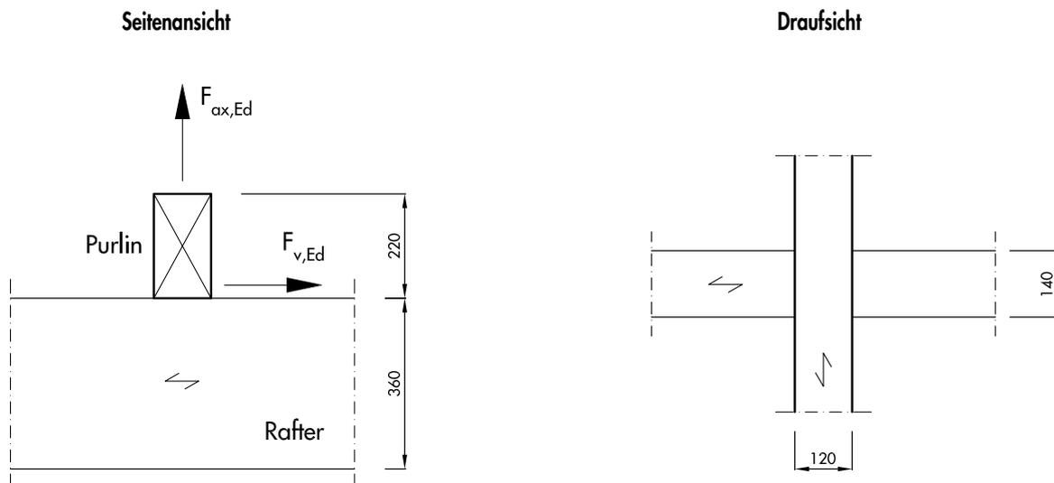
→ nach Bemessungstabellen für Paneltwistec AG SK, axiale Tragfähigkeit, mit  $A = h_p = 220 \text{ mm}$
