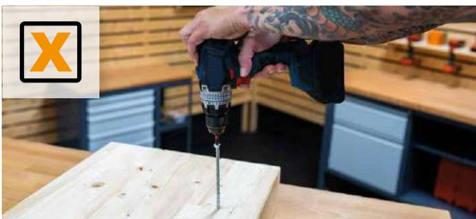
Üben Sie während der Installation **nicht zu viel Druck aus**, da dies schlanke Schrauben verformen kann, sodass das gewünschte Ergebnis nicht erreicht wird.
