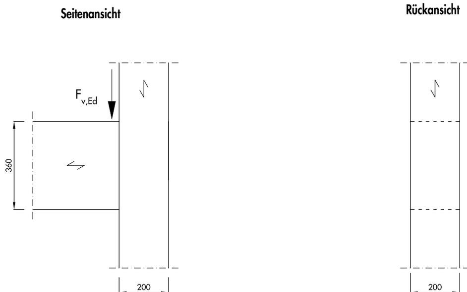
→ nach Paneltwistec AG Tellerkopfschrauben-Bemessungstabellen, seitliche Tragfähigkeit, mit  $A = w_P = 200 \text{ mm}$
