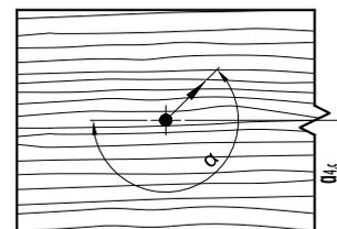
**Notizen:** Die Mindestabstände für seitlich tragende Schrauben basieren auf EN 1995:2014 unter Berücksichtigung einer Weichholzdichte von  $\rho_k \leq 420 \text{ kg/m}^3$ , wobei  $d$  = Schrauben-Nenndurchmesser. Bei Holz-Holz-Anschlüssen müssen die Achsabstände von  $a_1$  und  $a_2$  um 1,43 erhöht werden.
