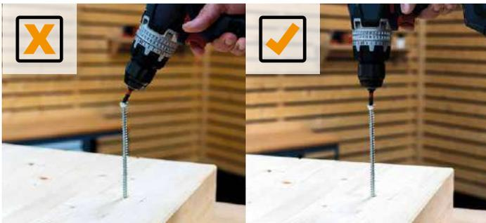
**Führen Sie** den Bit vollständig in das Elektrowerkzeug ein und **ziehen Sie ihn** ganz an. Achten Sie immer darauf, dass der Bit und der Schraubenkörper **zu Beginn** und während der Installation ausgerichtet sind, um **ein Ausreißen des Bits zu vermeiden** und die korrekte **Drehmomentübertragung sicherzustellen**. Der Bit muss vollständig in den Schraubenkopf eingeführt sein.
