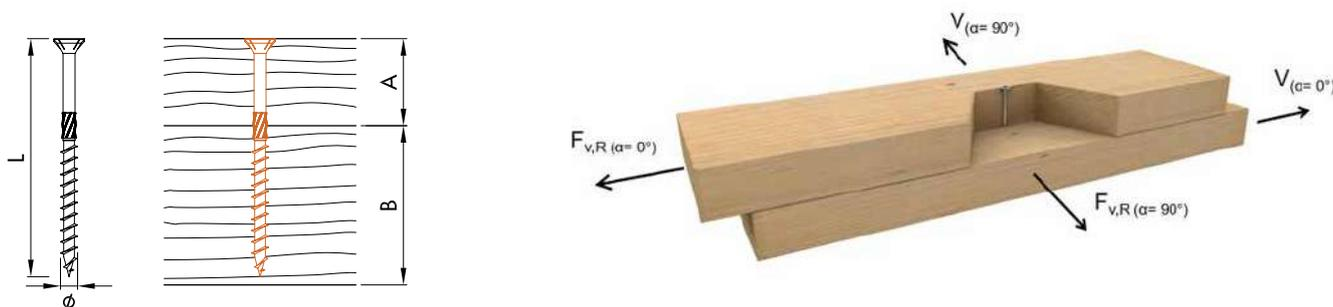
**Axiale und Schertragfähigkeiten von Schrauben mit den notwendigen Mindestlängen.**
