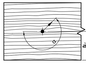
**Notizen:** Die Mindestabstände für seitlich tragende Schrauben basieren auf EN 1995:2014 unter Berücksichtigung einer Weichholzdichte von  $\rho_k \leq 420 \text{ kg/m}^3$ , wobei  $d$  = Schrauben-Neendurchmesser. Bei Holz-Holz-Anschlüssen müssen die Achsabstände von  $a_1$  und  $a_2$  um 1,43 erhöht werden.
