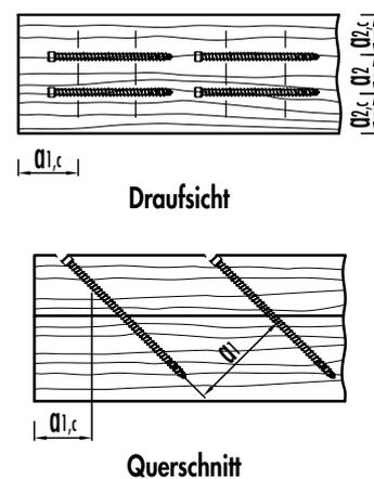
Notizen: Die Mindestabstände für axial belastete Schrauben entsprechen der ETA-11/0024 unter Berücksichtigung einer Weichholzdichte von  $\rho_k \leq 420 \text{ kg/m}^3$ , wobei  $d$  = Schraubennennendurchmesser, Mindestholzdicke  $t = 10 \cdot d$  und Mindestbreite  $w = \max [8 \cdot d; 60 \text{ mm}]$ . Bei Stahl-Holz-Anschlüssen können die Achsabstände  $a_1$  und  $a_2$  um den Faktor 0,7 verringert werden.
