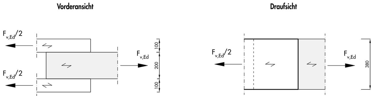
→ nach KonstruX ST ZK Bemessungstabellen, Tragfähigkeit von Scher-Zug-Schrauben, mit  $A = h_s = 100 \text{ mm}$
