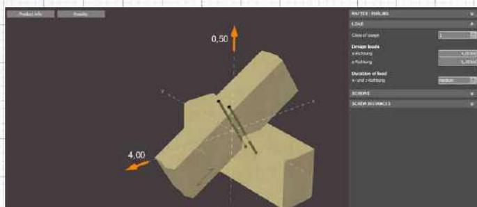
Modul für Sparren-Pfettenanschlüsse mit Panelwistec- und KonstruX.
