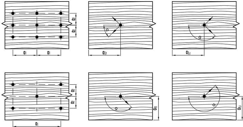
Bei Stahl-Holz-Anschlüssen dürfen die Mindestabstände  $\alpha_1$  und  $\alpha_2$  um einen Multiplikationsfaktor von 0,7 verringert werden.
