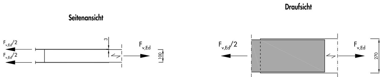
→ nach Bemessungstabellen Paneltwistec AG SK, laterale Tragfähigkeit, mit  $A = b = 100$  mm,  $t_s = 3$  mm (Dünublech)
