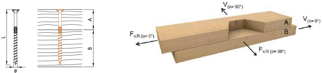
Axial- und Schertragfähigkeiten von Schrauben mit den notwendigen Mindestlängen.
