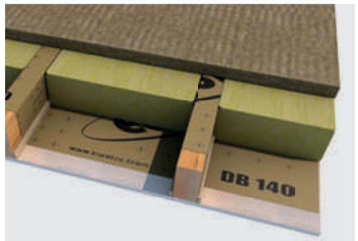
Die Membranen in der Dampfbremsschicht sind zum Schutz der Wärmedämmung gegen das Eindringen von Wasserdampf integriert. Die einzigartigen Eigenschaften des Produkts ermöglichen eine aktive Regulierung der Dampfübertragung, wodurch Kondensation und die daraus resultierenden Schäden an Holzkonstruktionen verhindert werden. In der Dachsanierung kann die DB140 auch schlaufenförmig verlegt werden.
