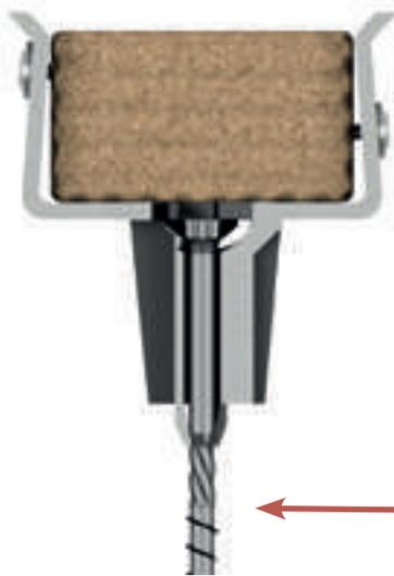
Panelwistec Schieferschraube 4,0 x 30 mm
