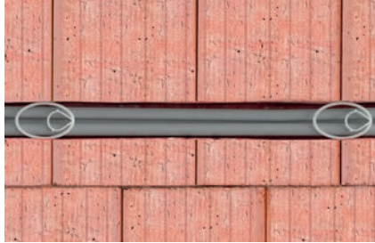
Kabelbefestigung in Wandschlitzten > 30 mm
