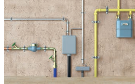
Befestigung von Leitungen
