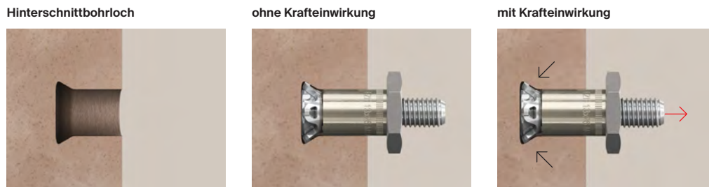
Hinterschnittbohrloch und Verhalten des Zykonplattenankers FZP II mit und ohne äußere Krafteinwirkung
