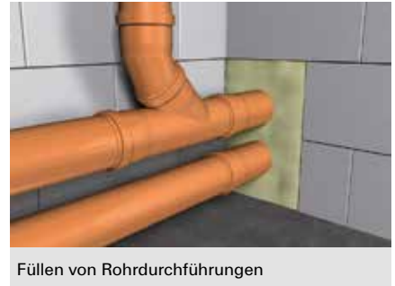
Dämmen und Füllen von Mauerdurchbrüchen
