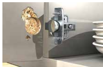
Reparatur ausgerissener Scharniere
