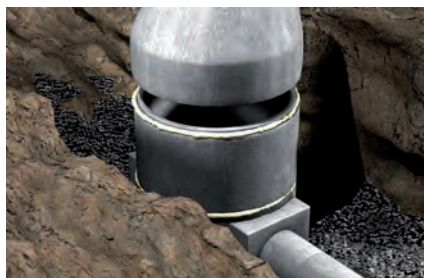
Abdichten von Beton-Schachtringen
