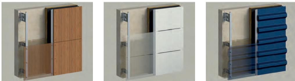
**Vertikales und horizontales Unterkonstruktionssystem** – zur verdeckten Befestigung von Fassadenbekleidungen
