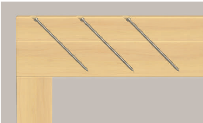
Balkenaufdopplung (nachgiebig verbundener Biegeträger)
