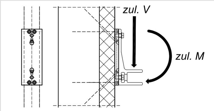
Größe der Adapterplatte = Größe der Markisenkonsole 80 ( $b_{Ad}$ ) x 220 ( $h_{Ad}$ ) mm
