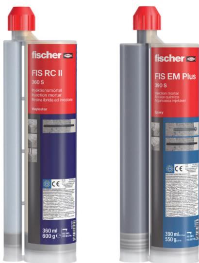
Der fischer Injektionsmörtel RebarConnect FIS RC II ist die wirtschaftliche Wahl für nachträgliche Bewehrungsanschlüsse im Durchmesser 8 – 32 mm und auch für tiefe Verankerungen bis zu 2 Meter. In Kombination mit dem passenden Hohlbohrer entfällt die Bohrlochreinigung als zusätzlicher Arbeitsschritt für eine schnelle Montage. Darüber hinaus ist eine Nutzungsdauer von 100 Jahren und die Verarbeitung des FIS RC II bei Temperaturen von -10° C bis +40° C in der ETA geregelt.
