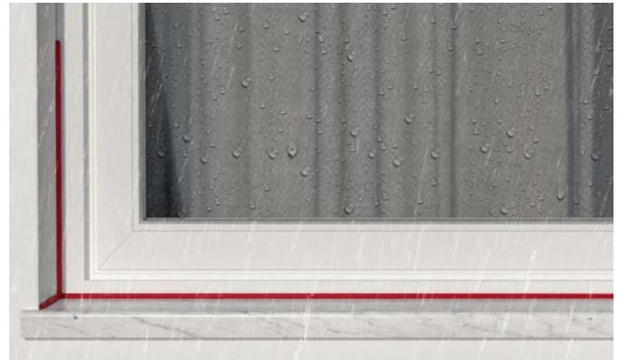
Dichtungsfugen im Außenbereich
