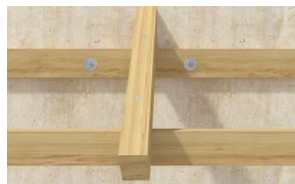
Verankerungen von Pfetten und Streichbalken
