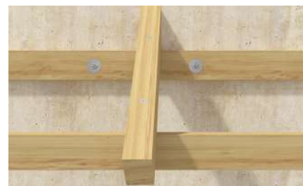
Pfetten / Streichbalken an Wand
