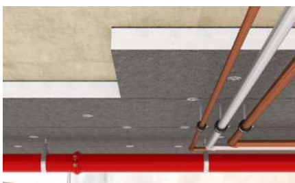
Befestigung von Dämmplatten
