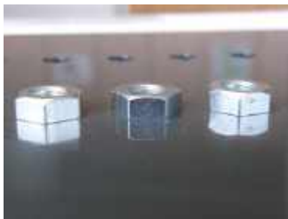
Eingezogene Mutter nach dem Bearbeitungsvorgang.
