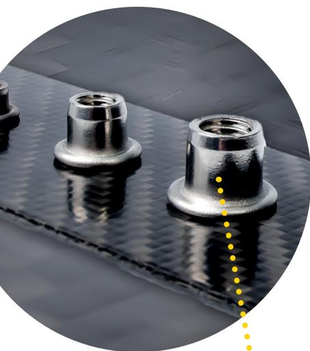
Die **GESIPA® SoftGrip® Blindnietmutter** ermöglicht das Einbringen von Gewinden in sensiblen und sehr weichen Materialien wie z.B. Kunststoffbauteile, Leichtbauplatten etc., ohne dabei zu große Spannungen durch Lochleibung und Flächenpressung in den Bauteilen zu erzeugen. Bauteilebeschädigungen wie Quetschungen, Risse, Weissbruch bei Kunststoffen, etc. werden somit vermieden.
