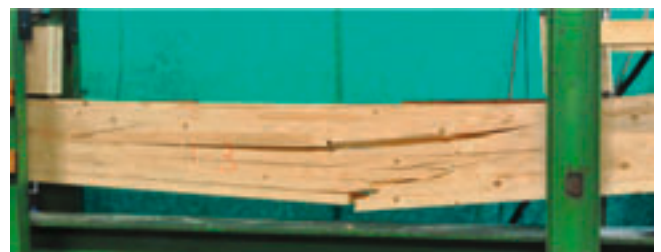
Versagensbild: Biegezugversagen des Nebenträgers
