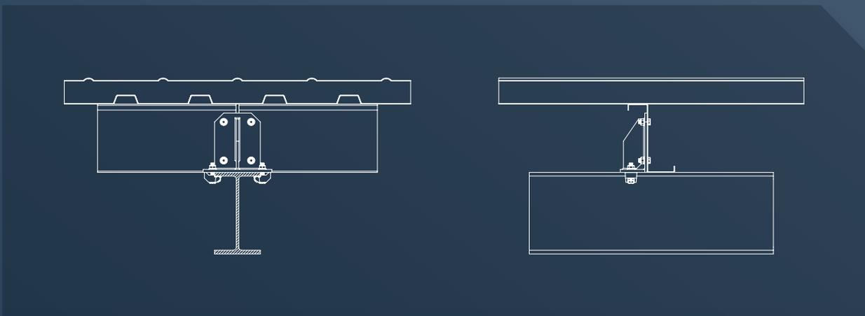
Mit einem Stahltragwerk verbundene Dachkonstruktion. Die verstellbare Anordnung ermöglicht die präzise Positionierung der Pfetten.
