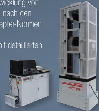
**(Oben)** Eine von zwei 1000-kN-Prüfmaschinen, die von Lindapter in der Forschung und Entwicklung benutzt werden
