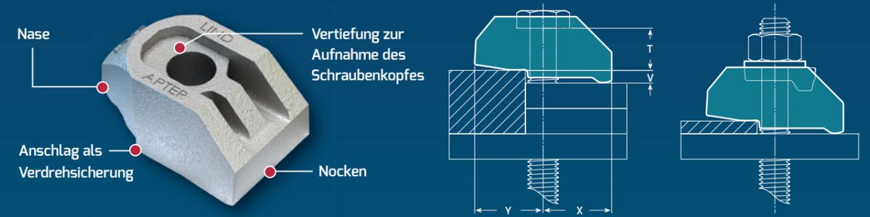
Material: Sphäroguss nach EN1563 Ausführung LT, feuerverzinkt nach EN ISO 1461.
