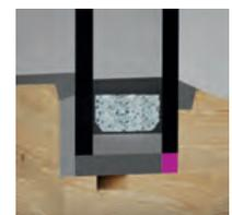
*Abdichtung am Flügelrahmen hinter der Glashalteleiste*
