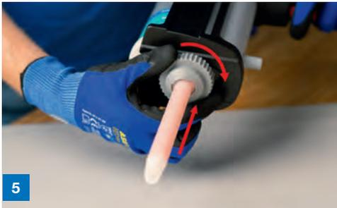
5 Statikmischer mit der Überwurfmutter fixieren
