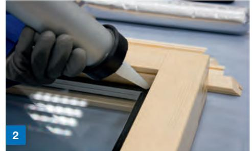
2 Abdichtung am Flügelrahmen hinter der Glashalteleiste
