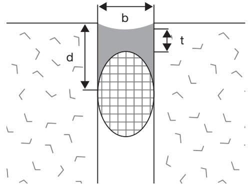
Diese Mindestfugenbreiten (b) gelten auch für die Anschlussfugen im Innenbereich für Dichtstoffe  $\geq 15\%$  zulässige Gesamtverformung.
