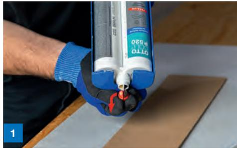
1 Einlegen der Kartusche in die Pistolenschale, Schutzkappe abschrauben und Stofen entfernen
