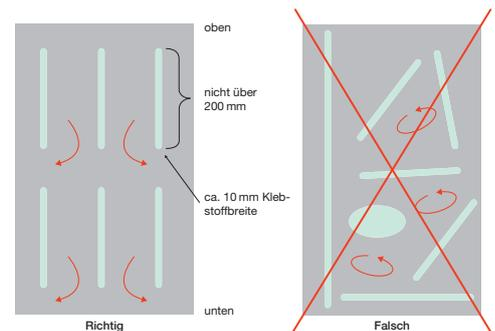
Ein Mindestabstand zwischen Spiegel und Untergrund von 1,6 mm ist zwingend einzuhalten, um das Einsperren des Vernetzer-Spaltprodukts in der endgültigen Position des Spiegels zu vermeiden. Dieser lässt sich auf zweckmäßigste Weise durch das Aufkleben von Abstandshaltern erreichen. Es sind die vom Institut des Glaserhandwerks in Hadamar geforderten Mindesthinterlüftungsabstände ([www.glaserhandwerk.de](http://www.glaserhandwerk.de)) für Spiegel gültig.
