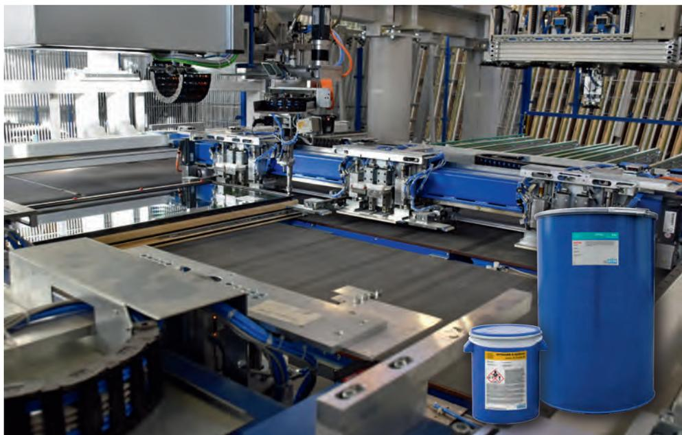
Vollautomatisierte Verarbeitung von OTTOCOLL® S81 z. B. bei der geklebten Verglasung auf beschichteten Holzoberflächen.
