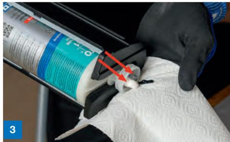
3 Material **ohne** Statkmischer ausdrücken, bis bei **beiden** Öffnungen Material austritt
