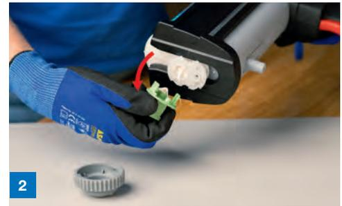
2 Überwurfmutter abschrauben und Stopfen entfernen
