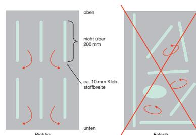
Für eine optimale Haftung oder Tragfähigkeit ist eine Haftfläche von mindestens 10 cm<sup>2</sup> in Raupenform pro kg Scheibengewicht erforderlich.
