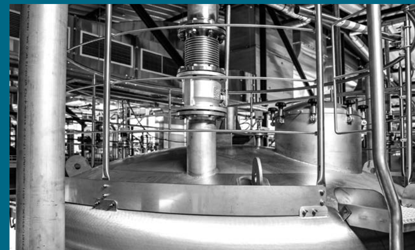
Geschlossene Mischeinheit zur Compoundierung.
