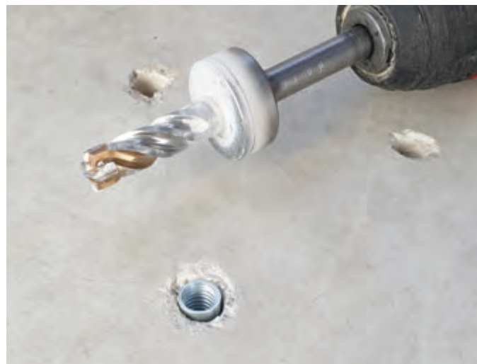
Zum Setzen von Einschlagankern
