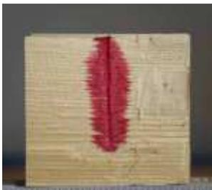
Der benötigte Holzbereich zum Eindrehen der Schraube ist ohne Vorbohren größer.
