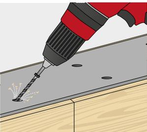
Zur Gewährleistung der korrekten Montage- richtung wird eine Pilotbohrung empfohlen.
