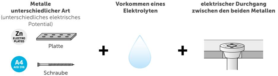
Je unähnlicher die Metalle (größere Potentialdifferenz), desto höher das Risiko einer Korrosion. Das Potential für galvanische Korrosion zwischen Metallen hängt davon ab, wie weit sie in der „elektrochemischen Spannungsreihe der Metalle“ voneinander entfernt sind. Eine Potentialdifferenz von mehr als 0,4-0,5 V könnte als signifikant/kritisch angesehen werden.
