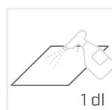
3. Die Oberflächen vor dem Auftragen des Schaums ausreichend befeuchten. Für eine ganze Dose sollte etwa 1dl Wasser verwendet werden.
