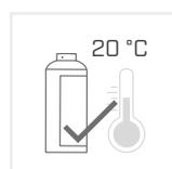
5. Die ideale Verwendungstemperatur beträgt ca. 20 °C. Bei zu hohen oder niedrigen Temperaturen müssen die Sprühdosen mit Wasser gekühlt oder erwärmt werden, um ihre optimale Wirksamkeit zu behalten.
