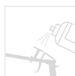
9. Wenn sich gehärteter Schaum an der Sprühpistole befindet, kann diese nicht mehr verwendet werden. Wenn die Pistole für längere Zeit nicht verwendet wird, muss sie mit dem entsprechenden Reinigungsmittel sorgfältig gereinigt werden.
