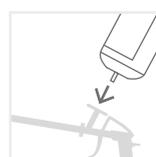
8. Um das Gewinde der Sprühdose nicht zu beschädigen, die Dose auf eine ebene Fläche stellen und die Pistole langsam anschrauben.
