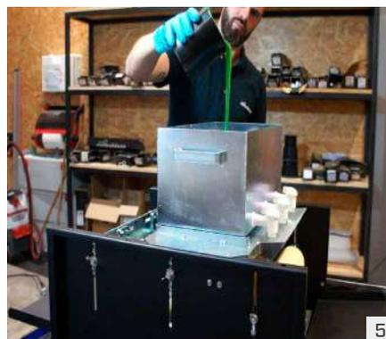
Farbe einfüllen. Bei Bedarf bis zu einer homogenen Konsistenz umrühren.
