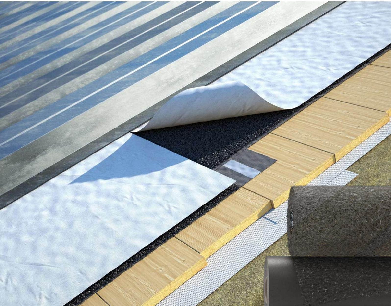
TRASPIR METAL ist eine hochdiffusionsoffene Bahn, kombiniert mit einer dreidimensionalen Matte und Schutzfilz. Der obere Filz verhindert das Eindringen von Verunreinigungen in die Matte und verbessert durch Vorbeugen von Staunässe die Hinterlüftung. Eine einzigartige Schalldämmlösung, die vor Ort auf Schalldämmleistung gegenüber Regengeräuschen auf der Dachfläche geprüft wurde.
