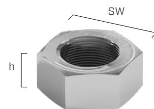
\* Die Norm ISO 4032 unterscheidet sich von der Norm DIN 934 bezüglich der Parameter h und SW bei den Durchmessern M10, M12, M14 und M22.
