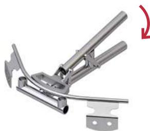
2. Das Eckelement mittels Hebelbewegung der Biegevorrichtung verbiegen.
