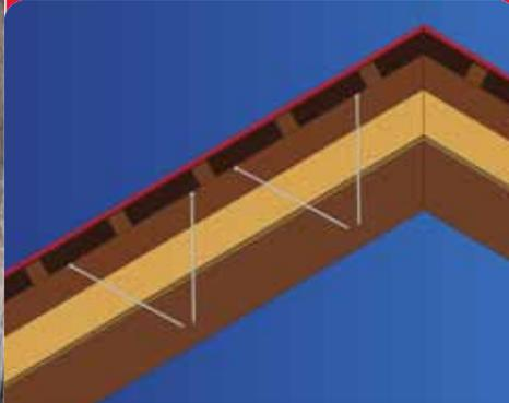
Die RAPID® Top-2-Roof – optimale Geometrie für die **Befestigung von Aufdachdämmungen!** Aber auch in der **Sanierung und Aufbringung von Dämmungen an an Wänden** findet die Top-2-Roof immer mehr Anwendungsgebiete
