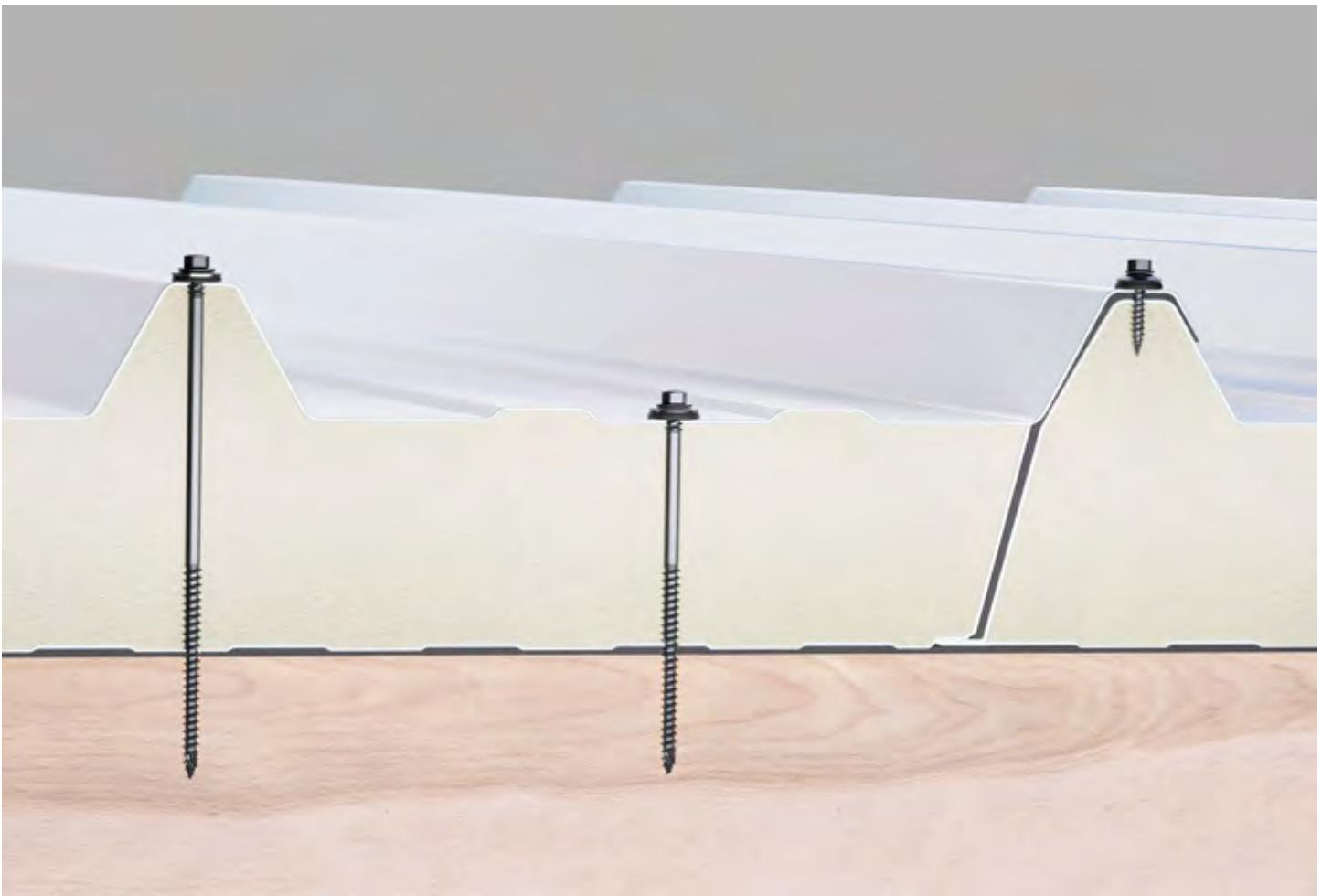
**Befestigung von Sandwichelementen in einem Arbeitsgang: Die SXC-Bohrbefestiger von SFS sind speziell für die hohen Anforderungen bei Sandwich-Systemen entwickelt worden. Dynamische Belastungen durch Temperatureinwirkungen, Begehen oder Windlasten haben keine negativen Auswirkungen auf die Funktionalität der Befestigungen. Stützgewinde, gewindefreie Zone und die abgestimmte Dichtscheibe ergeben eine dauerhaft dichte Verbindung.**
