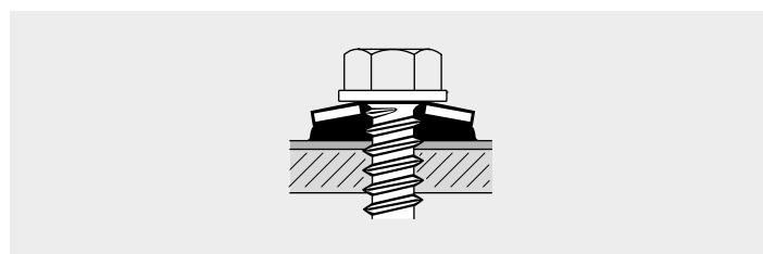
**Minimales Risiko von Undichtheiten** durch optimales Komprimieren des dicken EPDM.
