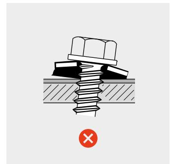
Die Verwendung eines Tiefenanschlags wird empfohlen.
