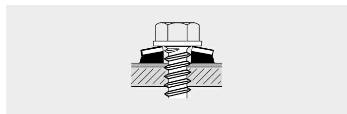
**Hohes Risiko von Undichtheiten** durch geringeres Komprimieren des dünnen EPDM.
