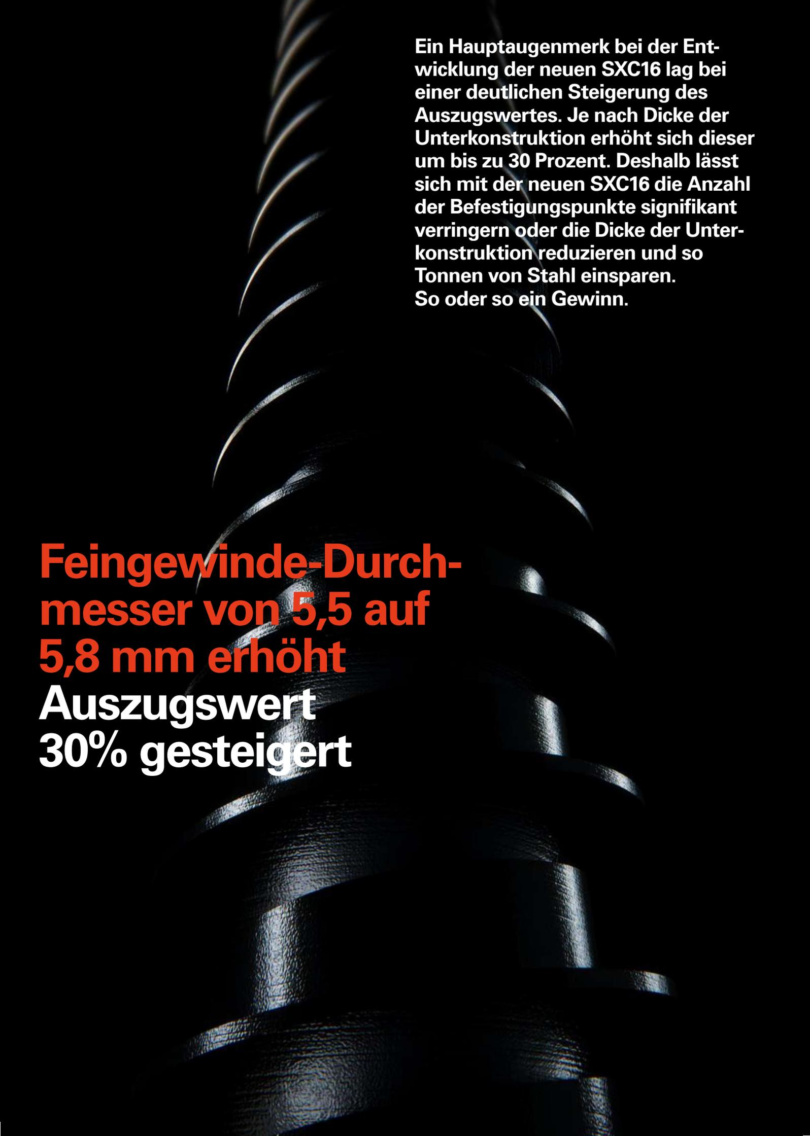
Ein Hauptaugenmerk bei der Entwicklung der neuen SXC16 lag bei einer deutlichen Steigerung des Auszugswertes. Je nach Dicke der Unterkonstruktion erhöht sich dieser um bis zu 30 Prozent. Deshalb lässt sich mit der neuen SXC16 die Anzahl der Befestigungspunkte signifikant verringern oder die Dicke der Unterkonstruktion reduzieren und so Tonnen von Stahl einsparen. So oder so ein Gewinn.
