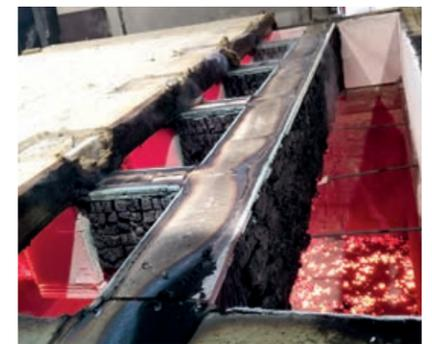
^ SHERPA Prüfstand: Insgesamt wurden 4 belastende Prüfkörper für R90 und R120 geprüft und die Verformungen gemessen.
