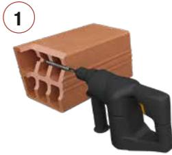
1. Bohrloch drehbohend erstellen. Durchmesser und Bohrtiefe beachten.
