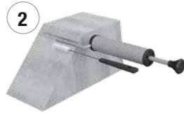
2. Bohrloch mit Bürste reinigen und ausblasen. Druckluft (6 bar) für Bohrungen hef  $\geq 10d$  oder  $> \varnothing 22 \text{ mm}$  : 4x Ausblasen, 4x Bürsten, 4x Ausblasen.
