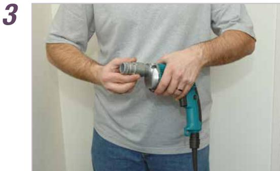
Montieren Sie den QD-Adapter auf den Schrauber.
