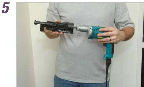
Stecken Sie den Schraubervorsatz auf den Adapter und lassen ihn einrasten.
