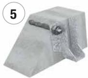
5. Während der Verarbeitungszeit kann die Gewindestange nachjustiert bzw. Mörtelfehlmengen nachinjiziert werden. Der Anker darf erst nach der Aushärtezeit belastet werden.
