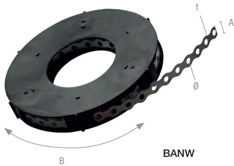
BANS und BANW Lochbänder werden zur Verankerung von Holzbauteilen im niederen Lastbereich und als konstruktive Anschlüsse verwendet. Typische Verwendungsbereiche sind Spielgeräte, Leitungsbefestigungen, leichte Deckenabhängungen und Eckhalterungen.
