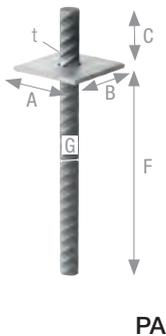
PA Pfostenhalter sind für leichte, nicht tragende Konstruktionen geeignet.
