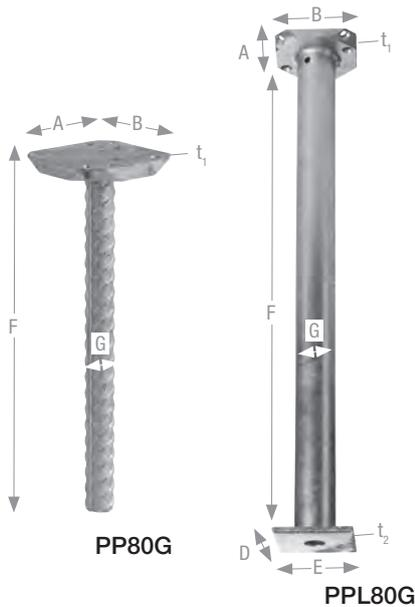
PP80G / PPL80G Stützenfüße sind für Holzbreiten ab 100 mm geeignet und werden direkt im Beton eingesetzt. Dabei darf der maximale Abstand der Druckplatte zum Beton beim Typ PP80G 50 mm und beim Typ PPL80G 250 mm betragen. Es können vertikale und horizontale Lasten aufgenommen werden.
