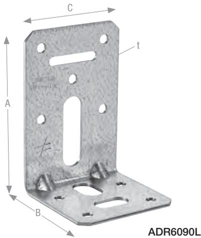
ADR Winkelverbinder können für Holz/Beton, Holz/Mauerwerk, Holz/Stahl oder Holz/Holz Verbindungen eingesetzt werden. Das Langloch in den Winkeln ADR6191 und 6292 bietet eine Montageausgleichmöglichkeit.
