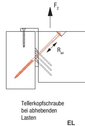
Tellerkopfschraube bei abhebenden Lasten
