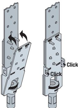
**Schritt 2:** Deckel und Boden des Bandlock® Pro mit einer Zange zusammendrücken, bis der Deckel in die beiden seitlichen Klemmen eingerastet ist.
