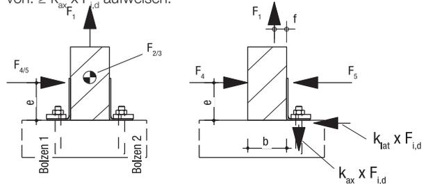
Bei Anschlüssen mit mehr als einem Bolzen beziehen sich die angegebenen Faktoren auf die Bolzengruppe.
