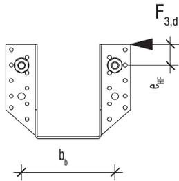
Bei der Verwendung mit 4 Ankerbolzen
