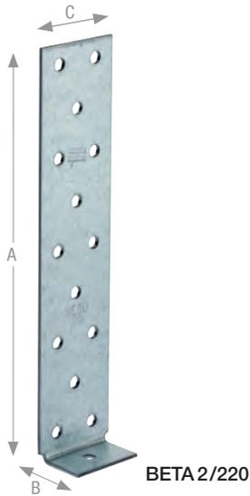
BETA Zuganker werden als Zugverbindung von Holzbauteilen an Beton verwendet. Es werden 5 verschiedene Größen in je 2,0 und 4,0 mm Blechdicke produziert. Die in der Tabelle angegebene Länge entspricht der Nutzlänge inkl. des abkanteten, kurzen Schenkels (22 mm).
