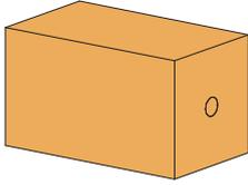
Anreißen und einbringen einer Zentrumsbohrung
