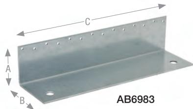
Schubwinkel sind in erster Linie zur Aufnahme von horizontalen Schubkräften bei Wandtafeln, Aussteifungshölzern und Verblockungen vorgesehen. Je nach Ausführung sind sie für Holz / Holz- Konstruktionen oder Verbindungen von Holz an Beton geeignet.
