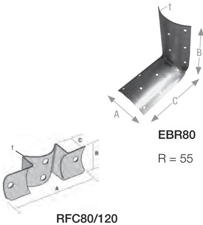
Diese Winkel sind speziell für die Montage von Rundhölzern entwickelt worden. Durch die gekrümmte Form der Schenkel sind sie vielseitig einsetzbar.
