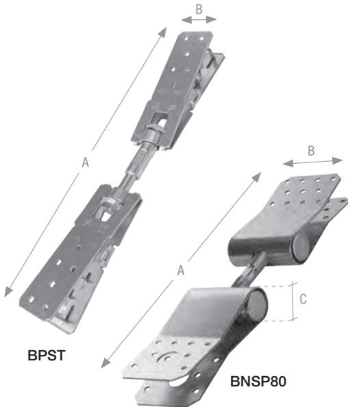
BNSP / BPST Spanngeräte werden in Verbindung mit dem Windaussteifungssystem bereits während der Montage eingebaut, oder nachträglich in vorhandene Konstruktionen, in denen ein kontrolliertes und wirksames Nachspannen notwendig geworden ist. Dazu wird im Sparrenfeld aus dem vorhandenen Windrispenband die erforderliche Länge herausgetrennt und das Spanngerät eingefügt. Mit einem Gabelschlüssel kann dann die erforderliche Spannung hergestellt werden.
