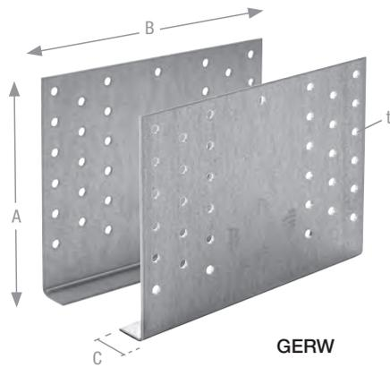
GERW Gerberverbinder eignen sich für die Gelenkausbildung von stumpf gestoßenen Durchlaufträgern. Neben Querkräften in vertikaler und horizontaler Richtung können sie Kräfte in Stabrichtung aufnehmen und eignen sich daher zur Weiterleitung von Verbandskräften. In Abhängigkeit von der Belastung kann zwischen Teil- und Vollausnagelung gewählt werden.
