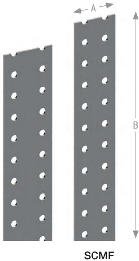
Die neuen SCMF Geschossverbinder von Simpson Strong-Tie® sind weitere Bausteine im System der zweiteiligen Zuganker und lassen sich aufgrund der durchgehenden Lochung schnell und flexibel an jede Geschossübergangshöhe anpassen. Ihre Wunschlänge „B“, im Raster von 20 mm, wird aus 2480 mm langen Basisstreifen kurzfristig zugeschnitten und zum Versand gebracht.
