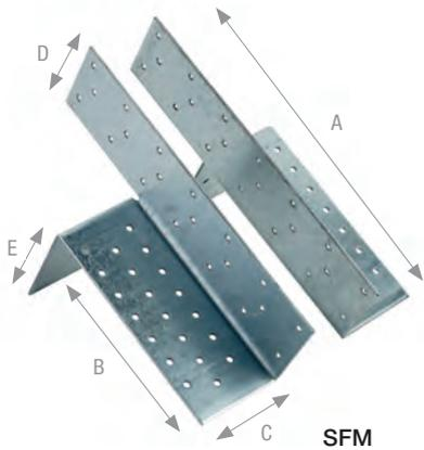
SF/SH Sparrenfußverbinder werden satzweise (rechts + links) am Binderuntergurt und einer Fußschwelle bzw. an Sparren und Pfetten befestigt. Sie sind zur Übertragung von Normalkräften aus Binderkonstruktionen oder Sparren in schubfest verankerte Schwellen geeignet. SHLM und SHLS Schwellenhalter gewährleisten die Weiterleitung der Horizontalkräfte in eine Betondecke.
