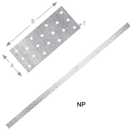
NP Lochbleche und Lochblechstreifen werden aus sendzimirverzinkten Blechen in den Dicken 1,5 mm, 2,0 mm, 2,5 mm und 3,0 mm hergestellt. Der Lochdurchmesser beträgt 5 mm.
