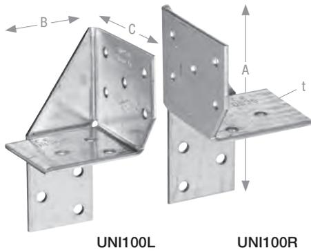
UNI Verbinder werden für Holz/Holz-Anschlüsse verwendet. Je Anschluss sollten zwei Verbinder diagonal gegenüberliegend angeordnet werden. Bei dieser Anordnung der Verbinder je Anschluss werden entweder 2 linke oder 2 rechte Verbinder benötigt.
