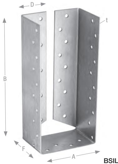
BSIL Balkenschuhe sind insbesondere zum Anschluss von Balken an Stützen konzipiert. Somit lassen sich bei 1-achsiger Belastung Balken an gleich breite Stützen anschließen. Bei einer 2-achsigen Belastung sind die Randabstände gemäß EC5+ NA für die Nägel in der Stütze zu beachten.
