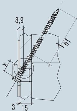
$$R_{1,d} = \min(6^{0,9} \times 66,9 \times 265 \times 0,86 \times 0,9 / 1,3; 78,3 / 0,9 \times 0,9 / 1,3) = \min(52,9; 60,2) = \mathbf{52,9 \text{ kN}}$$
