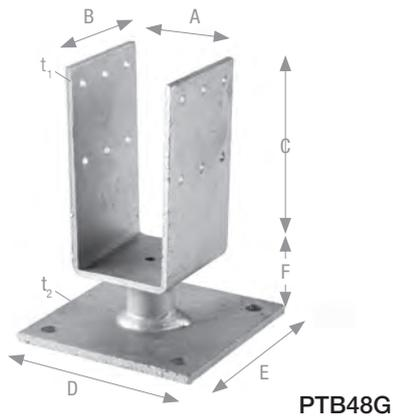
PTB48G Pfostenhalter mit U-Form eignen sich für leichte Konstruktionen im nicht tragenden Bereich. Der Anschluss am Betonfundament erfolgt mit Ankerbolzen und die Befestigung am Holz mit CNA Kammnägeln oder CSA Verbinderschrauben.
