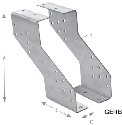
GERB Gerberverbinder werden für die Gelenkausbildung von Durchlaufträgern verwendet. Ein Satz Gerberverbinder besteht aus einem rechten und einem linken Ansteil und kann für Pfettenbreiten ab 80 mm eingesetzt werden. GERB Gerberverbinder sind für die gängigsten Holzabmessungen erhältlich.
