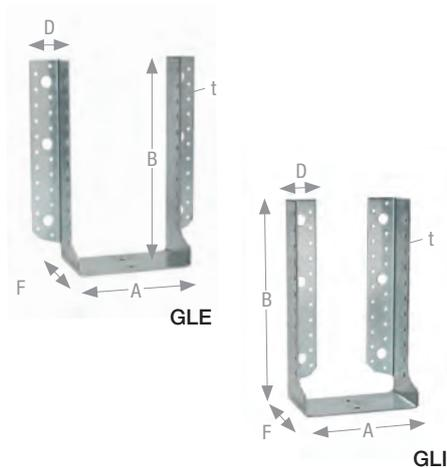
GLE / GLI Balkenschuhe sind als Standardbalkenschuhe für größere Abmessungen geeignet und können Lasten in alle Richtungen abtragen. Die Mehrfachlochung ermöglicht einen Anschluss sowohl an Hauptträger aus Holz, als auch aus Beton. GLI nur für Anschlüsse an Holz.
