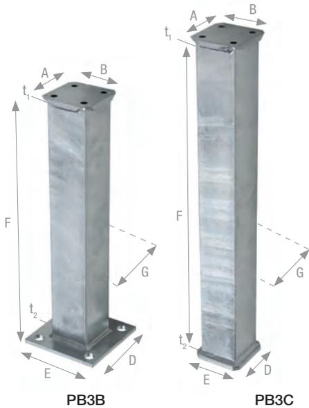
PB3B und PB3C Stützenfüße erfüllen die Anforderungen an den baulichen Holzschutz gemäß DIN 68800 und die Fachregeln des Zimmererhandwerks. Aufgrund der großen Rohrlängen werden die erforderlichen 300 mm freier Abstand zur Bodenoberfläche, auch bei hohen Stützlasten, sicher eingehalten.
