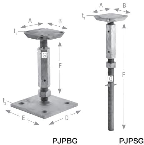
PJPBG / PJPSG Stützenfüße sind für Holzbreiten ab 100 mm geeignet. PJPSG Stützenfüße werden direkt im Beton eingesetzt. Dabei muss die Gewindestange mind. 200 mm im Beton einbinden. Eine Höhenverstellung ist mit der Langmutter auch nach der Montage noch möglich. Es können vertikale und horizontale Lasten aufgenommen werden.
