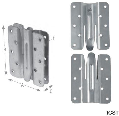
ICST Elementverbinder bestehen aus zwei gleichen Teilen, die an den Stoßflächen der zu verbindenden Elemente angeschraubt bzw. angenagelt werden. Es ist an nur einem Element eine Aussparung von 15 mm Tiefe erforderlich, bei einer 15 mm dicken Beplankung ist lediglich ein Ausschnitt an entsprechender Stelle nötig.
