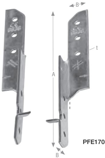
PFE Pfettenanker werden für die Zugverankerung von sich kreuzenden Hölzern verwendet und sollten vorzugsweise diagonal gegenüberliegend verbaut werden. Neben den Zugkräften können horizontale Kräfte aufgenommen werden. Belastungsabhängig kommen 2 oder 4 Pfettenanker pro Anschluss zur Anwendung. Bei 2 Pfettenankern pro Anschluss werden 2 linke oder 2 rechte Verbinder benötigt. Die PFE werden satzweise (rechts + links) verkauft. Die Einschlagzacke dient als Montagehilfe.
