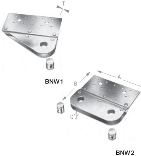
BNW Windverbandanschlüsse ermöglichen einen flexiblen Anschluss von Stahldiagonalen z. B. in einer Holzhallenkonstruktion. Die Verbinders werden in die Dachträger eingeschlitz und mit Stabdübeln angeschlossen.
