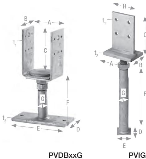
PVDBxxG / PVDxxG Stützenfüße sind in der Breite verstellbar, sowie auch nach der Montage höhenverstellbar. Sie passen für alle Stützenbreiten zwischen 80–120 mm, bzw. 120–160 mm. PVIG und PVIBG Stützenfüße sind vor der Montage höhenverstellbar und werden über ein Schlitzblech und Stabdübel mit dem Holz verbunden.
