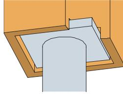
Bei Stützenfüßen zum Aufdübeln sollte eine Sperrschicht zwischen Stützenfuß und Beton eingebaut werden um die Zinkschicht keiner Dauerfeuchte auszusetzen.
