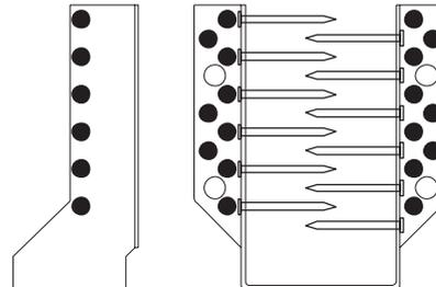
Die versetzte Anordnung der Nägel im Nebenträger vermeidet das Spalten der Hölzer bei schmalen Abmessungen.
