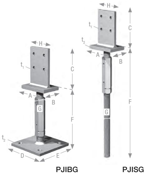
PJIBG / PJISG Stützenfüße sind für Holzbreiten ab 80 mm geeignet. PJISG Stützenfüße werden direkt im Beton eingesetzt. Dabei muss die Gewindestange mind. 200 mm im Beton einbinden. Eine Höhenverstellung ist mit der Langmutter auch nach der Montage noch möglich. Es können vertikale und horizontale Lasten aufgenommen werden.
