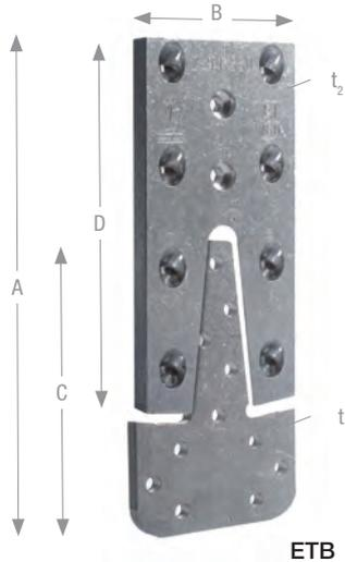
ETB-Passverbinder eignen sich sowohl für Hauptträger-Nebenträgeranschlüsse als auch für Stützen-Nebenträgeranschlüsse. Sie können mit Schattenfuge oder verdeckt liegend eingebaut werden und sind in Einschubrichtung belastbar. Es können Anschlüsse mit Neigungen von  $-15^\circ$  bis  $+90^\circ$  und Schrägen von  $15^\circ$  bis  $165^\circ$  ausgeführt werden. Bei entsprechenden Überdeckungen ist der Verbinder für Konstruktionen mit Brandschutzanforderungen bis 30 Minuten verwendbar.
