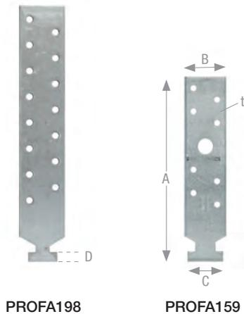
PROFA Profilanker wurden für die Verbindung von Holz an Ankerschienen entwickelt und eignen sich zur Aufnahme von Zugkräften. Zur zentrischen Lastenleitung wird eine gegenüberliegende Montage mit 2 PROFA empfohlen.
