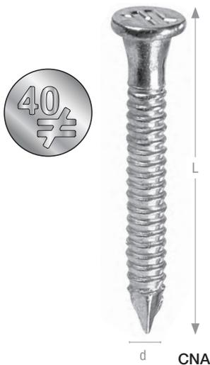
CNA Kammnägel wurden speziell für die Befestigung von Simpson Strong-Tie® Holzverbindern entwickelt. Der konische Ansatz des Schaftes unter dem Nagelkopf gewährleistet bei Stahlblech-Holz-Nagelverbindungen eine exakte Kraftübertragung. Die Werte der Tragfähigkeit sind in der ETA bzw. EN geregelt. CNA Kammnägel sind zur Identifizierung im eingeschlagenen Zustand, auf dem Kopf mit der Nagellänge gekennzeichnet.
