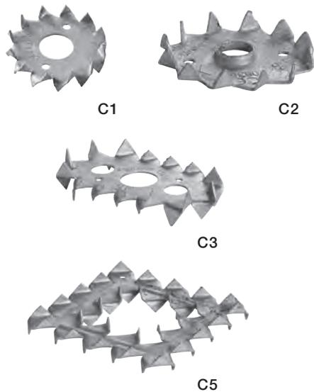
BULLDOG®-Dübel werden als ein- oder zweiseitige Scheibendübel mit Zähnen hergestellt. Zweiseitige BULLDOG®-Dübel werden ausschließlich für Holz an Holzanschlüsse eingesetzt, während die einseitigen BULLDOG®-Dübel auch für Verbindungen mit Stahlblechen oder an Beton verwendet werden. BULLDOG®-Dübel entsprechen der EN 912 „Dübel besonderer Bauart“.
