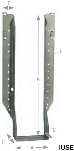
IUSE Verbinder und die Stegträger sollten idealerweise gleich hoch sein, um die Obergurte der Träger seitlich zu halten. Erreichen die Verbinder nicht die Nebenträgerhöhe, werden Stegverstärkungen im Nebenträger notwendig. Die oberseitigen Anschlaghilfen können bei tiefer liegenden Anschlüssen nach oben abgekantet werden.
