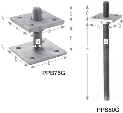
PPBxxG / PPS80G Stützenfüße sind höhenverstellbar und können vertikal belastet werden. Der PPS80G Stützenfuß muss mindestens 200 mm tief einbetoniert werden. Der Abstand ab Oberkante Beton bis zur Kopfplatte darf bei beiden Typen maximal 100 mm betragen. Die Kopfplatten sind lose abnehmbar.
