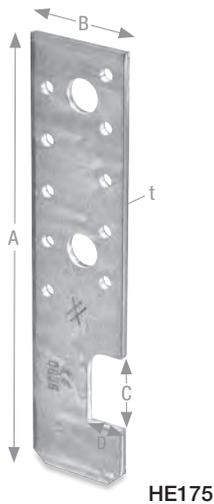
HE-Anker wurden zum Anschluss von Holz an Stahl-T-Profile entwickelt und eignen sich zur Aufnahme von Zugkräften. Zur zentrischen Lasteinleitung wird eine Montage mit zwei diagonal gegenüberliegenden oder vier HE-Ankern empfohlen. Die Länge kann gemäß ETA bis 315 mm hergestellt werden.
