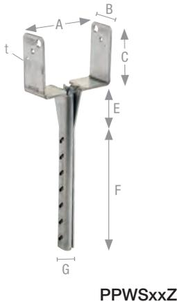
PBWSxxZ Stützenfüße werden ohne zu schweißen aus einem Stück Blech hergestellt. Die Dolle ist S-förmig gekantet, was ihr eine große Stabilität verleiht. PBWSxxZ sind in den Breiten 70; 90 und 100 mm verfügbar und bis in der Nutzungsklasse 2 anwendbar. Der Einbau erfolgt in Betonfundamente ab der Festigkeitsklasse C12/15. PBWSxxZ Stützenfüße können vertikale Druck- und Zuglasten aufnehmen und sind CE gekennzeichnet.
