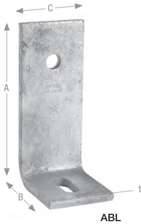
ABL/ABS Winkelverbinder können zur Befestigung von Holzbauteilen, Fenstern, Fassadenelementen auf oder an Beton eingesetzt werden. Die ABL Winkel haben zum Ausgleich von Montagetoleranzen ein Langloch und die ABS Winkel einen Schlitz im horizontalen Schenkel.
