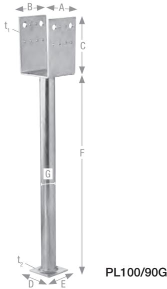
PLxxG Stützenfüße werden direkt im Beton eingesetzt und können Druck-, Zug- und horizontale Kräfte aufnehmen. Der Abstand der Unterkante des U-Profiles zum Beton darf bis 250 mm betragen.
