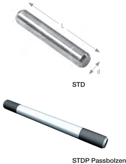
STD Stabdübel werden für Anschlüsse mit eingeschlitzten Stahlteilen im Holz (z.B. Balkenträger, Stützenfüße) oder für Holz-Holz Anschlüsse verwendet. Die Bohrungen im Holz müssen stets den Nenndurchmessern der Stabdübel entsprechen. Die Werte der Tragfähigkeit sind im EC5+NA definiert.
