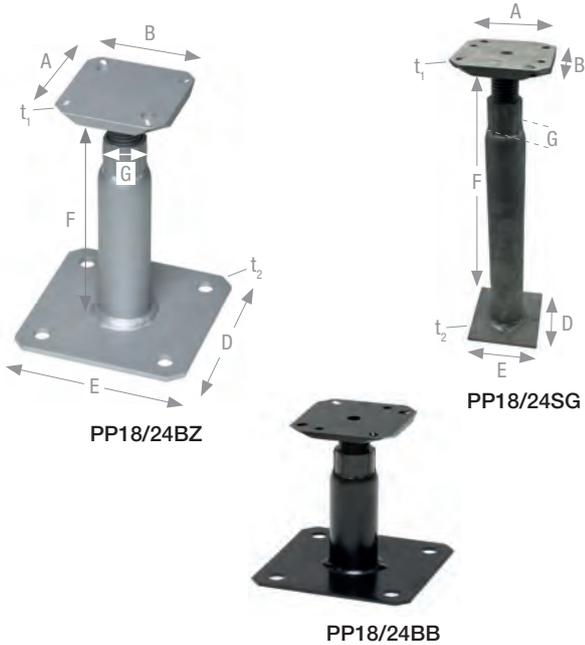
PP18/24xy Stützenfüße sind für Stützen ab 100mm Breite geeignet. Eine Höhenverstellung ist im Bereich von 180–240 mm möglich. Durch die Lastaufnahme in alle Richtungen sind die Stützenfüße vielseitig einsetzbar.
