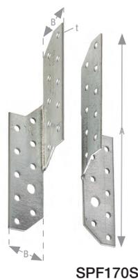
SPF Sparrenpfettenanker werden für die Zugverankerung von sich kreuzenden Hölzern verwendet. Neben Zugkräften können horizontale Kräfte aufgenommen werden. Belastungsabhängig kommen 2 oder 4 Pfettenanker pro Anschluss zur Anwendung. Bei Verwendung von zwei Sparrenpfettenankern sollten diese zur zentrischen Lasteinleitung diagonal gegenüberliegend angeordnet werden.
