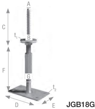
JGB18G Pfostenhalter werden mittels Ankerbolzen am Betonfundament angeschlossen. Das 16 mm Holzgewinde wird in eine Ø12 mm Bohrung bis zum Kontakt mit der Druckscheibe eingedreht. Durch die kraftschlüssige Verschraubung ist eine konstruktive Zugverankerung gewährleistet.
