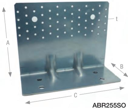
ABR255SO Winkelverbinder wurden zur Aufnahme von hohen Zug- und Schubkräften konzipiert, mit der Möglichkeit Schwellen und kleinere Aufkantungungen bis 100 mm Höhe überbrücken zu können. Die verschiedenen Nagelbilder erlauben viele Anschlussmöglichkeiten an Vollholz und an Brettsperrholz.
