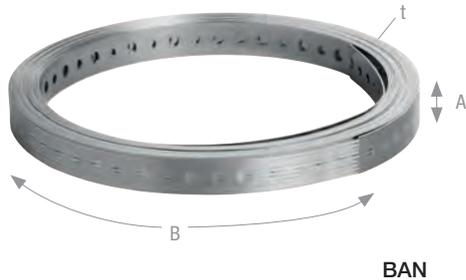
BAN Lochbänder sind in den Dicken 1,0 mm und 1,5 mm in jeweils verschiedenen Längen erhältlich. Die Bänder werden zur Verankerung von Holzbauteilen im niederen Lastbereich und als konstruktive Anschlüsse verwendet.
