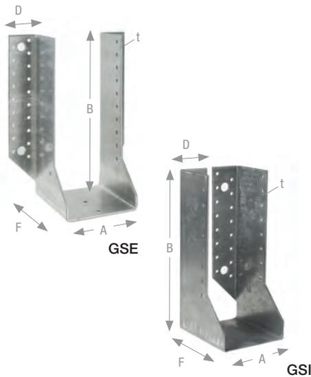
GSE / GSI Balkenschuhe werden in 4,0 mm Blechdicke hergestellt und sind vornehmlich zur Befestigung größerer Holzquerschnitte an Holz, der Typ GSE auch an Beton oder Stahl gedacht. Gemäß ETA-06/0270 dürfen GSE und GSI Balkenschuhe in der 4,0 mm Ausführung für Brandwiderstandsanforderungen bis 30 Min. eingesetzt werden. GSE / GSI Balkenschuhe können in alle Richtungen Lasten abtragen, für den Brandfall gelten die Regeln gemäß ETA. GSI nur für Anschlüsse an Holz.
