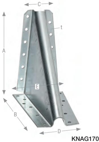
Knaggen werden zur horizontalen Lastaufnahme und Kippsicherung von Pfetten auf geneigten Bindern und Trägern verwendet. In Kombination mit Sparrenpfettenankern eignen sich die Verbinder sehr gut zur Windsogsicherung.
