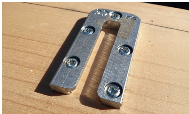
Bild 1 Verschraubung eines Verbinderbauteils ohne Drehmomenteinstellung. Der Verbinder drückt sich ins Holz ein
