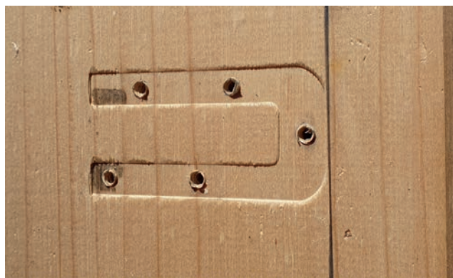
Bild 2 Erhebliche Eindrückungen durch eine zu starke Verschraubung
