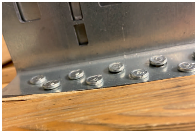
Bild 1: Zu hohe Drucklufteinstellung am Nagelgerät führt zum Einpressen und Verformen des Verbinders
