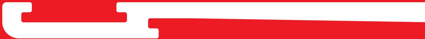
**SOUDAFRAME SWI (Soudal Window Installation) ist ein System für die Vorwandmontage aus glasfaserverstärktem Kunststoff (GFK).**
