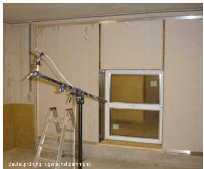
Bauteilprüfung gemäß ift-Richtlinie MO-01/1 Prüfstand mit Sensoren
