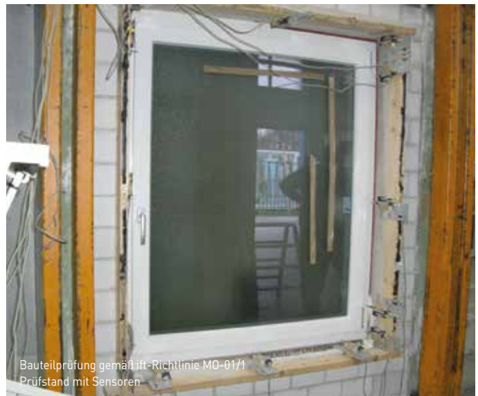
Bauteilprüfung gemäß ift-Richtlinie MO-01/1 Einbau des Fensters in den Prüfstand
